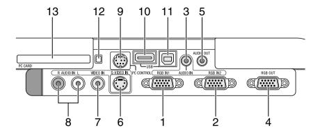
1. RGB IN 1 / Component Input Connector (Mini D-Sub 15 Pin)
