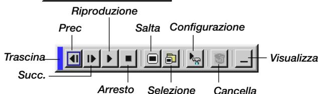
Alla pressione del tasto MENU, appare sul display la barra degli strumenti; alla seconda pressione del tasto MENU, appare il menù e ad ogni pressione successiva del tasto MENU, il display cambia tra il menù e la barra degli strumenti.
