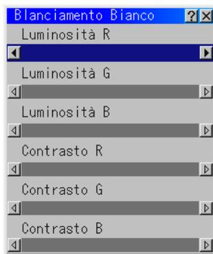
Utilizzare i tasti o del mouse pad per regolare il bilanciamento del bianco. La luminosità di ciascun colore (RGB) viene utilizzata per regolare il livello di nero dello schermo; il contrasto di ciascun colore (RGB) viene utilizzato per regolare il livello di bianco dello schermo.
