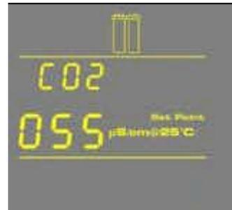
如果在 C01 中選擇電導率單位，則設定值可以在 0.999 μS/cm @25 °C 到 0.055 μS/cm @25 °C 範圍內進行調整。
