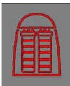
如果紅色純化柱警報圖標顯示為一個穩定的圖標，則表明 SynergyPak 沒有正確安裝或根本沒有安裝。如果 SynergyPak 已經重新安裝，但仍然顯示警報，請與我們聯繫。
