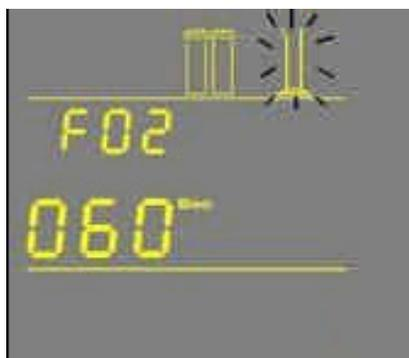
3. 按取水按鈕一次，系統取水60秒，顯示幕顯示計數器倒數計時。
