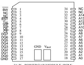
34-Pin POWERCAP MODULE (PCM) (USES DS9034PC POWERCAP)
