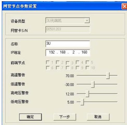
图 4-16. 3U 光端机网管节点参数设置
