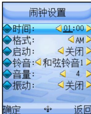
可通过[上导航键] 和[下导航键]选择闹钟各项设置值, [左导航键] 和[右导航键]设置值, 按下[OK键]确定设置完毕。
