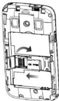
SD 卡的安装朝向示意图
