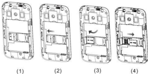
如图所示，取出电池面盖和电池后，将 SD 卡座盖片掀起，按图示箭头方向取出 SD 卡即可。
