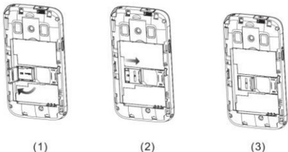
如图所示，取下手机电池面盖和电池，将 SD 的卡座翻起，将 SD 卡按照图示箭头方向放进卡座，再扣合 SD 卡座，完成 SD 卡的安装。
