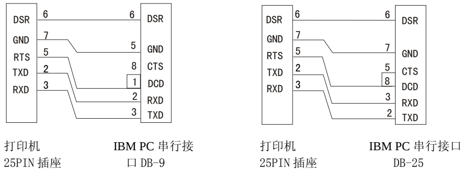
图 5-3 POS88III打印机串行接口与 IBM PC 串行口连接示意图
