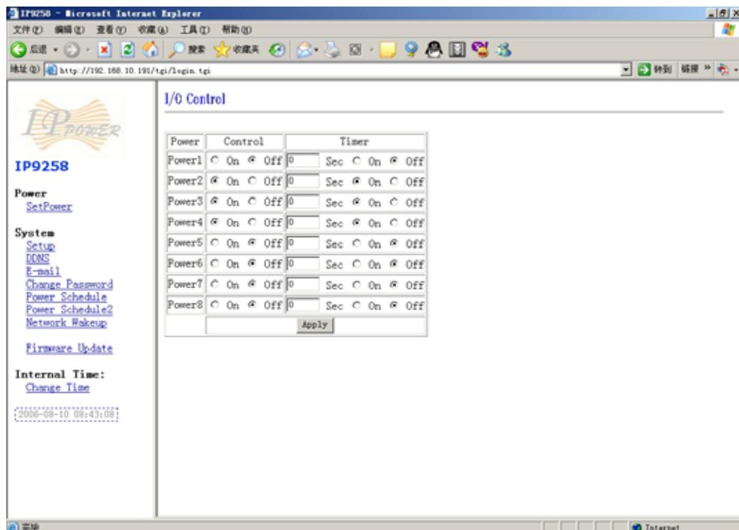
9258可控制8路独立电源供电，用户也可选择在一段时间后再打开或关闭某个电源插座，在timer选择区域中，相应的时间栏目中填入延时秒数，再选择延时后电源的电源动作“on”或者“off”。用户在完成了选择后，需点击“apply”按钮确认选择。
