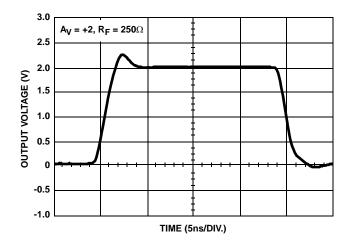
FIGURE 7. LARGE SIGNAL POSITIVE PULSE RESPONSE
