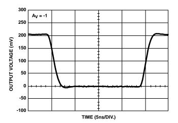
FIGURE 14. SMALL SIGNAL POSITIVE PULSE RESPONSE
