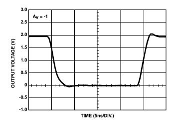
FIGURE 15. LARGE SIGNAL POSITIVE PULSE RESPONSE
