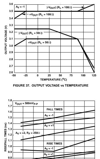
TEMPERATURE (°C) FIGURE 39. RISE AND FALL TIMES vs TEMPERATURE
