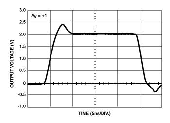
FIGURE 11. LARGE SIGNAL POSITIVE PULSE RESPONSE
