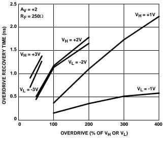
FIGURE 36. OVERDRIVE RECOVERY TIME vs OVERDRIVE
