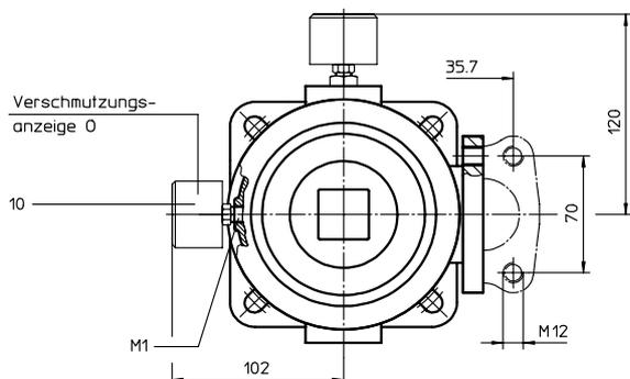
Bei Ausführung mit einem Verschmutzungsanzeiger soll vorzugsweise der Anschluß M1 genutzt werden.
