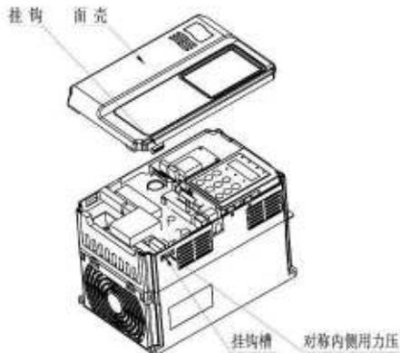
图 3-3 塑胶外壳下盖板拆卸图 (MD320H)
