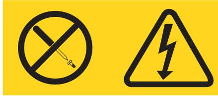
贴有此标签的所有组件内部都有危险的电压、电流和能量级别。这些组件内部没有可维修的部件。如果您怀疑其中的某个部件有问题，请联系技术服务人员。
