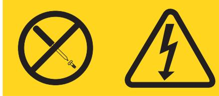
贴有此标签的任何组件内部都有危险的电压、电流和能量级别。这些组件内部没有可维修的部件。如怀疑这些部件中的某一个有问题，请联系技术服务人员。
