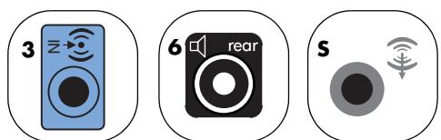
对于类型 3 接口系统，当激活多声道音频配置后，蓝色“音频线路输入”接口将用作“后置扬声器线路输出”。
