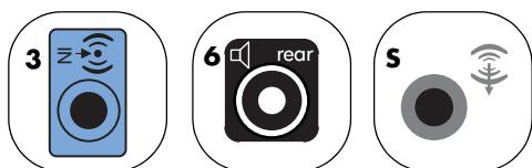
对于类型 3 接口系统，当激活多信道音频配置后，蓝色“音频线路输入”接口将用作“后置扬声器线路输出”。
