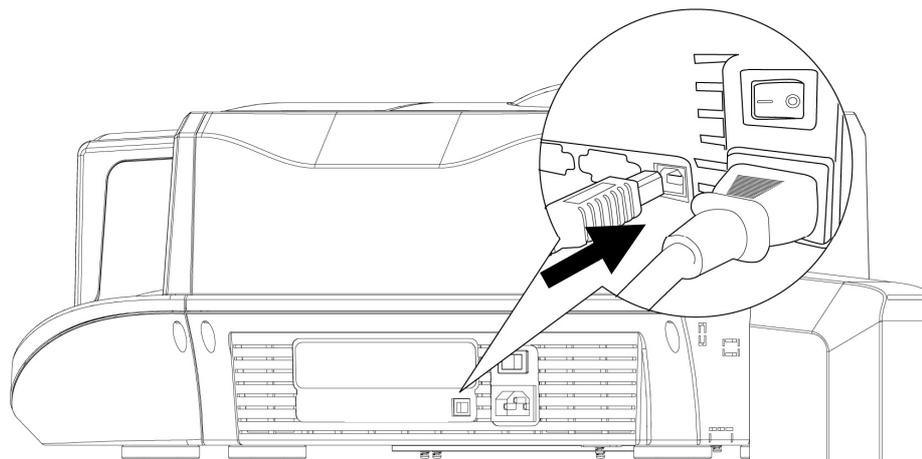
3. 开启电源开关，Status绿灯会保持光亮。开启电源前，请先确认您已安装驱动程序在您的计算机里，详细安装步骤请参考 第二章 软件安装。
