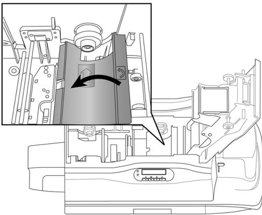
3. 用手维持清洁上盖打开的状态(否则清洁上盖会弹回), 将滚轮轴对准插孔, 装入清洁滚轮。安装完成后, 用手轻拨清洁滚轮, **确定清洁滚轮可以滑顺的转动, 即是正确安装完成**, 如有转动不顺畅、左右晃动或歪斜的状况, 请重新安装。
