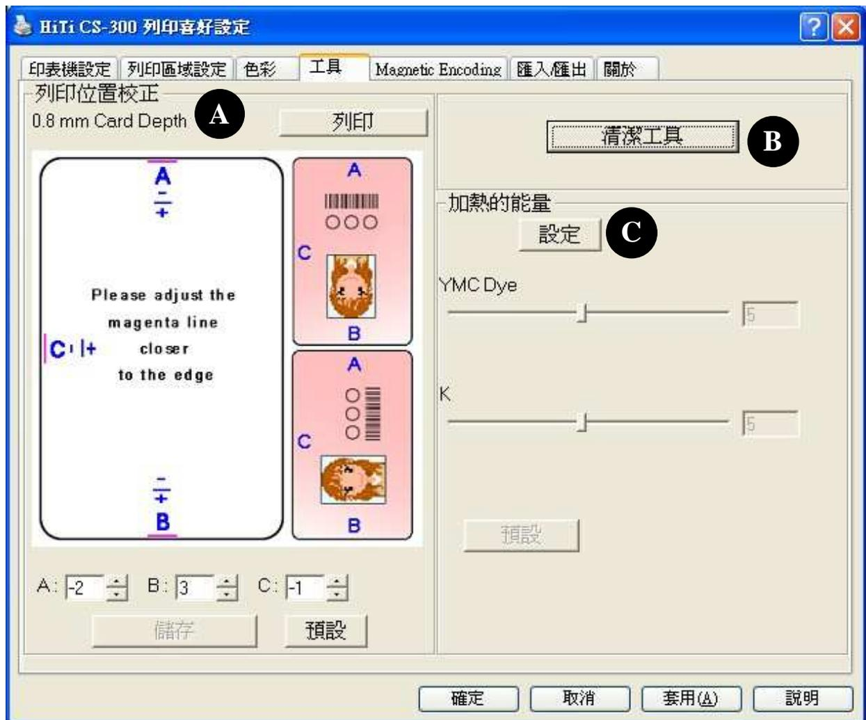
**A. 打印位置校正：**当卡片的打印出现白边时，您可以在 A、B 和 C 中填入数字以便调整打印的边界位置。请先按下打印按钮打印一张校正卡，并依据校正卡将红色线条尽量调整至接近卡片边缘为止。调整完成后，可按下Save Setting储存设定值。
