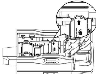
5. 关上色带门, 确认 LED 灯显示为绿色状态, LCD 显示” READY” 完成安装。
