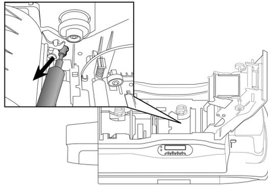
4. 将清洁滚轮于清洁卡的胶面反复滚动，即可轻松清除滚轮上的灰尘。
