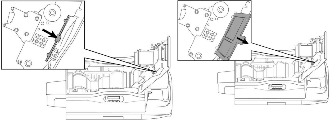
4. 装回滤网，关上色带门，完成安装后，即可再次使用。
