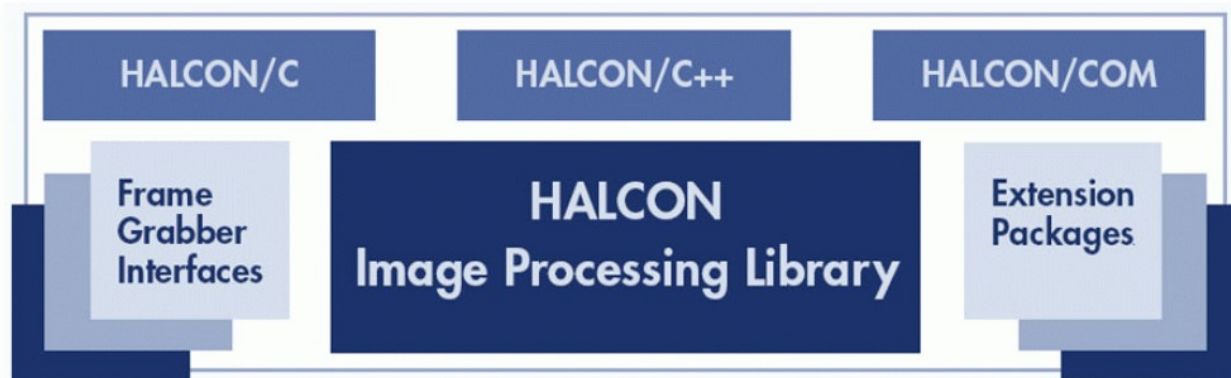
圖 2.2: HALCON 的基本架構
