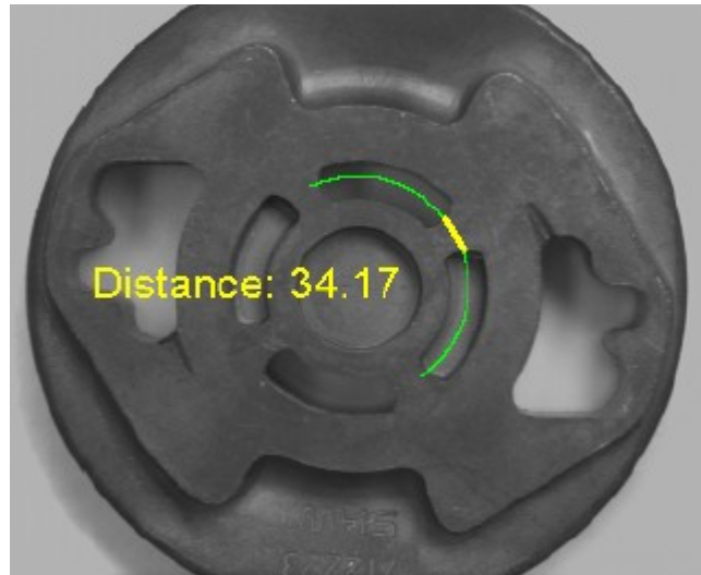
圖 3.6：測量洞與洞之間的距離
