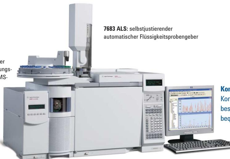
**7683 ALS:** selbstjustierender automatischer Flüssigkeitsprobengeber
