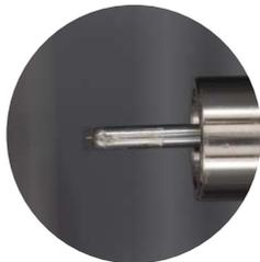
**Sachgerechte Säuleneinführung** – aktive Stellen werden vermieden, indem die Trennsäule über das Ende der Transferline hinaus eingeschoben wird.
