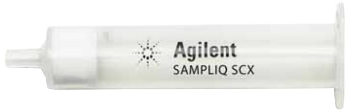
Agilents gemischtes SampliQ Strong Cation Exchange SCX-Polymerharz ist ein mit Sulfonsäure modifiziertes Divinylbenzol-Polymer mit Ionenaustausch- und Umkehrphasen-Retentionsverhalten. Dadurch zeigt das SampliQ SCX-Harz eine ausgezeichnete Retention sowohl für basische als auch neutrale Verbindungen über einen großen Bereich an Hydrophilie (log P). Zusätzlich ist das Harz inert gegen eine Vielzahl an Lösungsmitteln, mit Wasser benetzbar und von pH 0-14 stabil.
