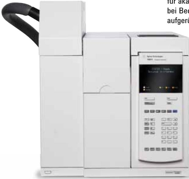
Der 7697A Headspace-Probengeber für 12 Probenflaschen ist mit den Agilent GC-Systemen der Serie 7820 kompatibel und kann auch mit den Agilent GC-Systemen der Serie 7890A eingesetzt werden.
