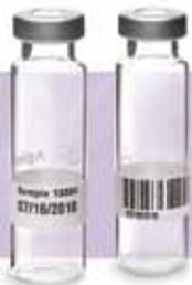
Zur Wahrung einer lückenlosen Kontrolle ermöglicht der mit Datenübertragungsfunktionen ausgestattete Strichcode-Leser des einzigartigen Agilent Headspace-Probengebers die Nachverfolgung der Proben bereits vor dem Eintritt in den Ofen. Dies ist unverzichtbar für Labore, die Blutalkoholanalysen oder andere Applikationen durchführen, bei denen maximale Bestätigung erforderlich ist.
