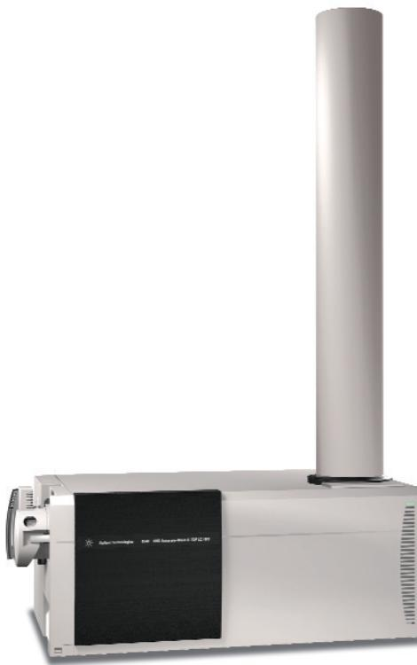
Das Agilent 6540 Q-TOF LC/MS ist mit Ultra High Definition TOF- und Agilent Jet Stream-Technologie sowie MassHunter Workstation-Datensuchfunktionen ausgestattet, die empfindliche, hochauflösende, massengenaue MS- und MS/MS-Analysen ermöglichen.
