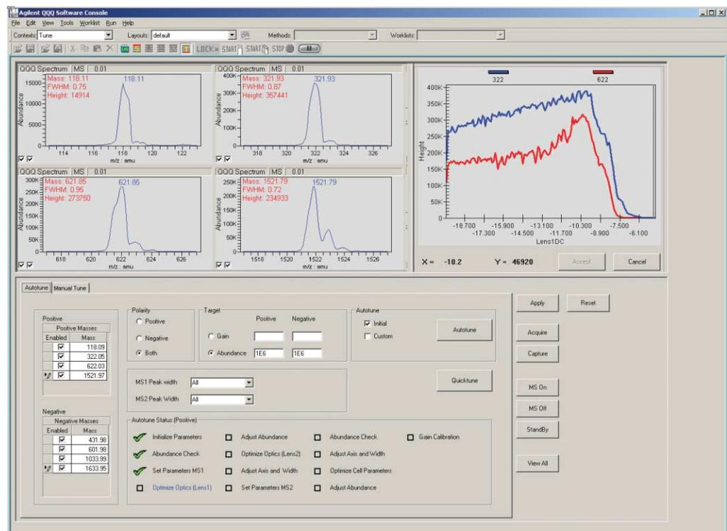
Die MassHunter Workstation Software für den 6410 enthält eine Reihe von Kalibrierungsoptionen - angefangen vom manuellen Tuning bis zum hier abgebildeten, voll automatischen Autotune-Programm, das maximale Leistung bei minimalem Aufwand gewährleistet.
