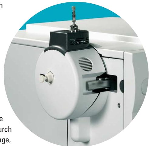
Die Agilent Multimode-Quelle (ESI/APCI) vereinfacht die Nutzung und maximiert den Durchsatz bei gleichzeitig überragender Leistung.
