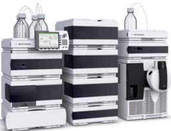
**Erweitertes Analyse-Aufreinigungssystem mit MS-Detektion und drei Fraktionssammlern für anspruchsvolle Applikationen.**
