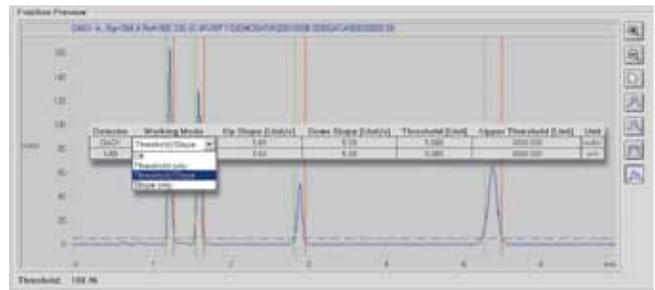
Es sind mehrere Modi für die Sammlung möglich, und mit der Fraktionsvorschau von Agilent ChemStation ist das Auffinden der korrekten Auslöseparameter äußerst einfach.
