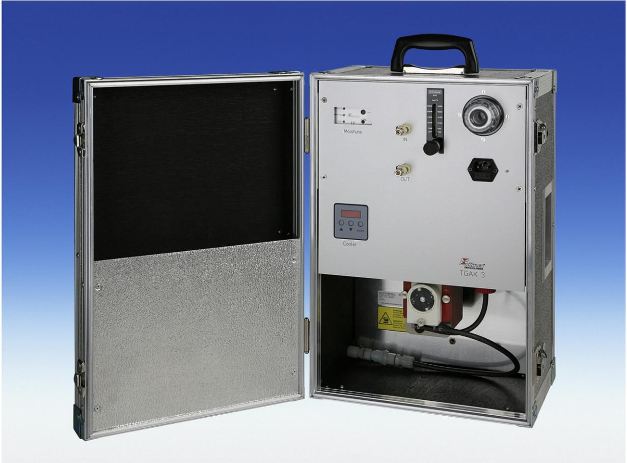
体积紧凑的样气处理系统在各种现场的精确气体分析中是倍受青睐的。TGAK3正是应此需要而设计的独立系统，它的体积只有登机箱大小。
