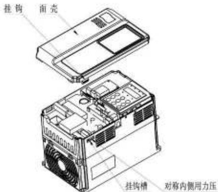
图 3-3 塑胶外壳下盖板拆卸图（MD320N）
