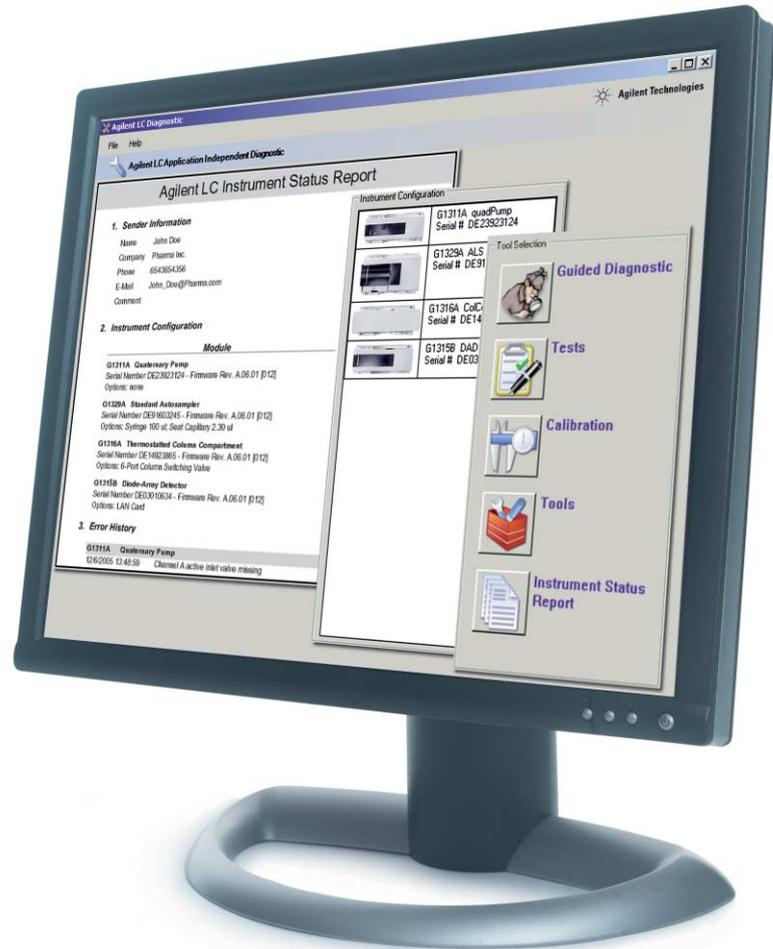
**Il suffit d'appuyer sur un bouton pour que le programme de diagnostics CPL Agilent élabore un rapport d'état complet de l'instrument au format pdf.**
