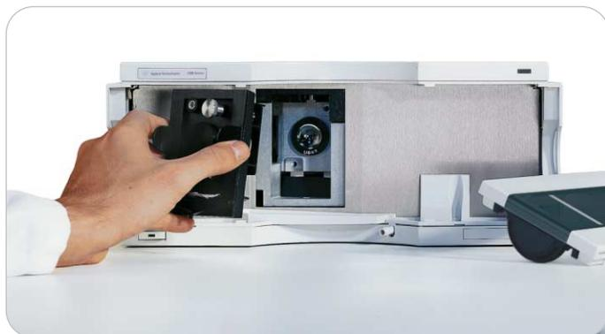
Accès frontal et autoalignement pour les pièces à remplacer comme la lampe ou la cellule.
