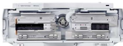
Système de chauffage et refroidissement à effet Peltier, régulation de 10 °C au-dessous de l'ambiante à 100 °C.
