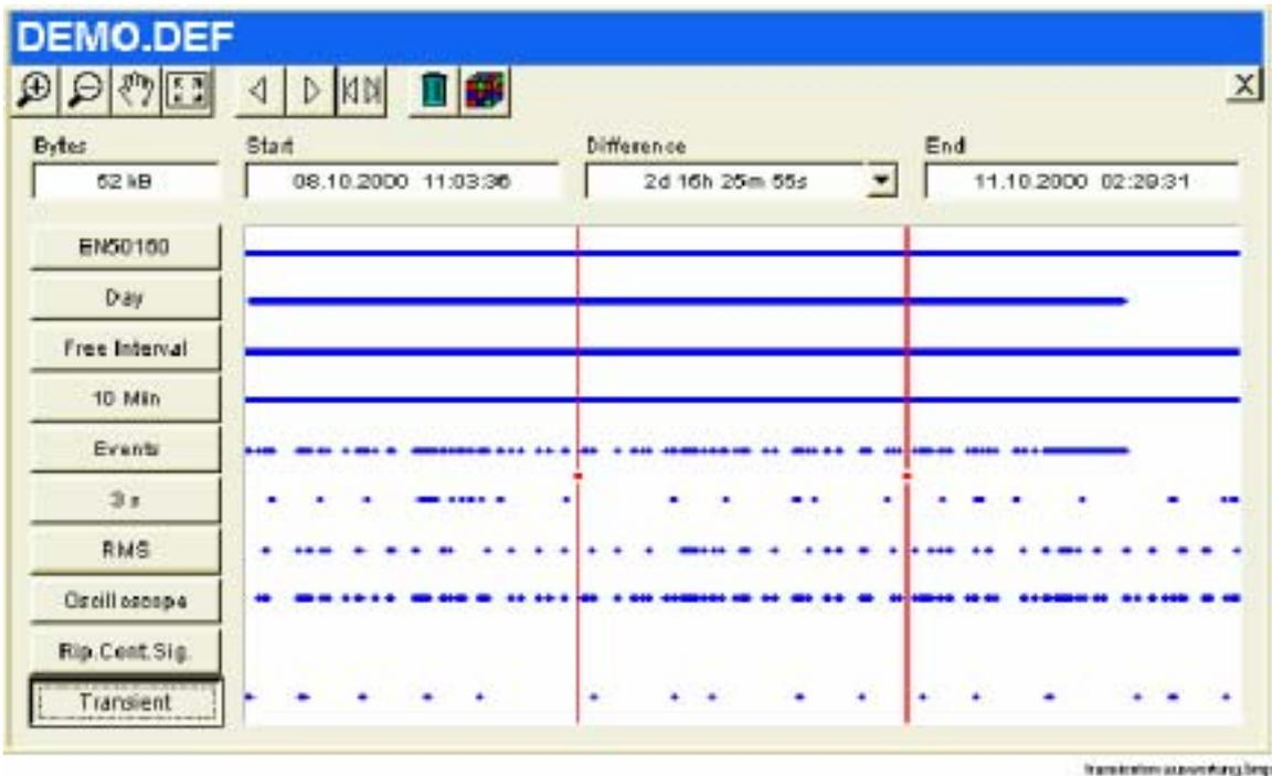
对于电压瞬变测量,可使用 CH1 (通道 1)至 CH4(通道 4)的通道。本系统提供 *level-time diagrams* (电平 - 时间图) 和 *spectrums* (频谱)。
