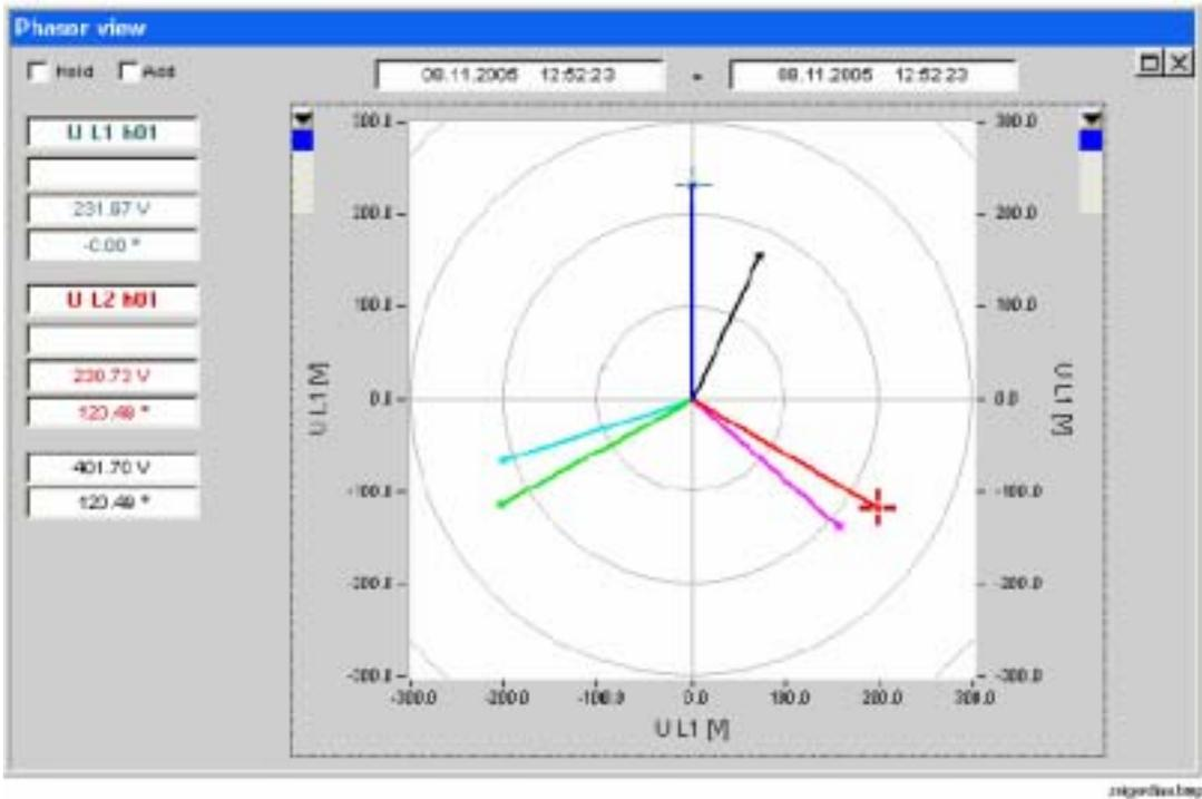
可显现电压和电流相位间关系及不同相位之间的关系，并可通过时标精确量化。
