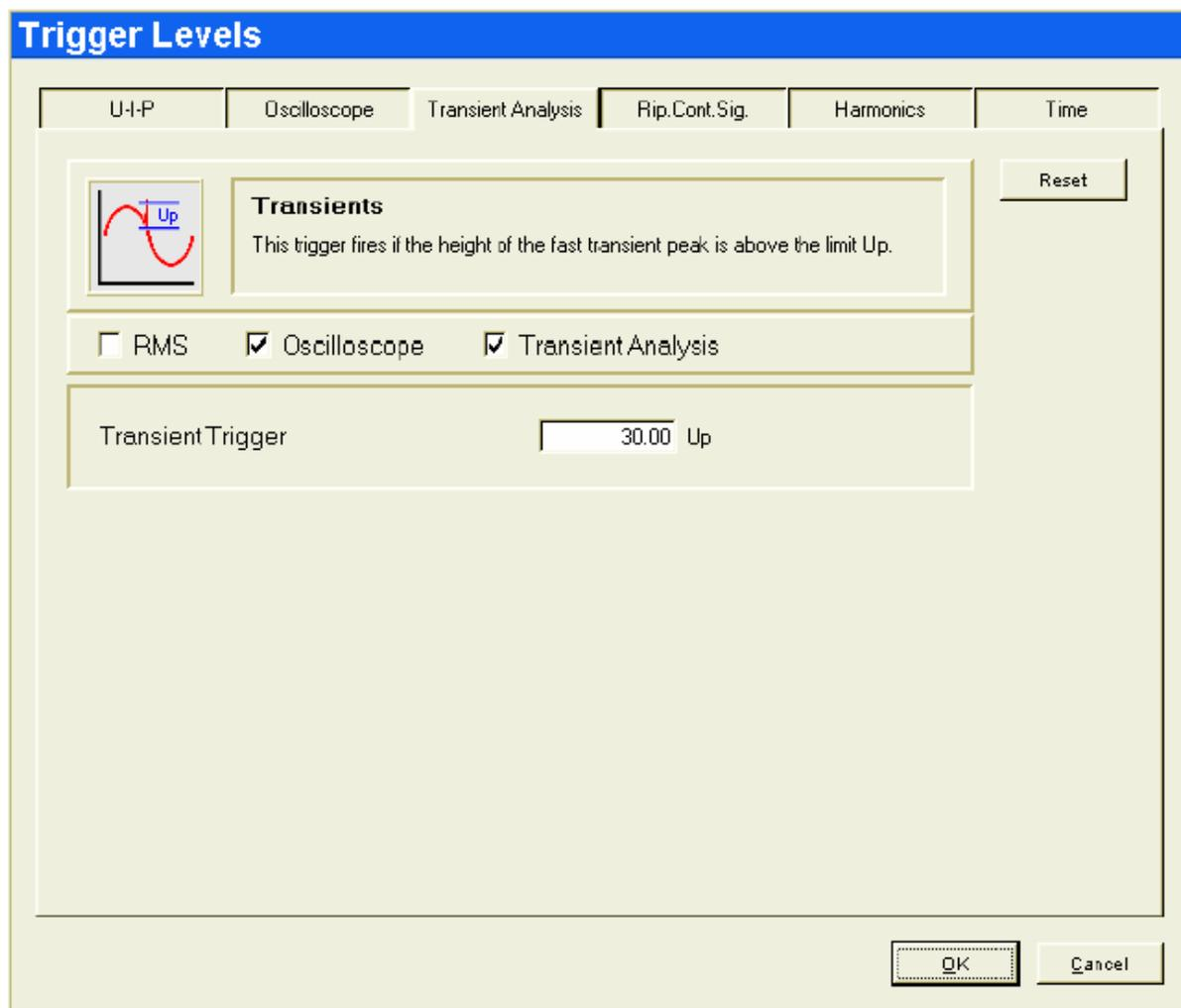
瞬态信号是配电网中发生的持续时间很短的干扰信号，这种信号的振幅高、斜率大，其中含有高频成分，因此输入信号在进入逻辑触发电路之前必须通过 1500 Hz 高通滤波器进行过滤。如果电压步进值超过设定值  $V_p$ ，系统将根据实际设定触发瞬态值、有效值和/或示波器值的记录功能。只要仪器上安装有瞬态信号选件，则 CH 1 - CH 4 通道上将可使用电压触发功能。标准瞬态选件的采样频率在 100 kHz ~ 500 kHz 范围内。如果使用扩展选件，该范围将会扩大至 100 kHz - 10 MHz。
