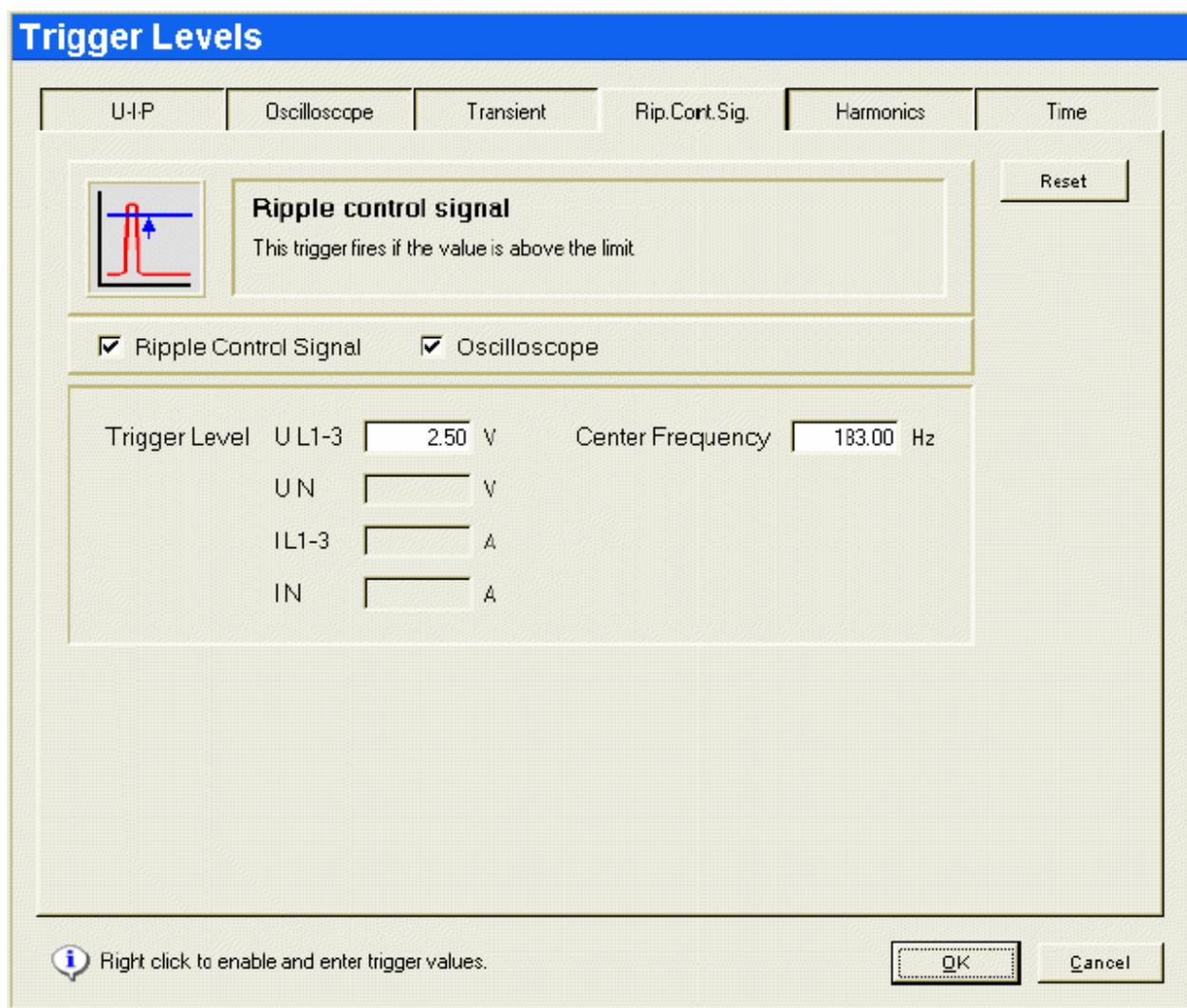
该触发功能可针对相电压、中线电压、相电流、中线电流使用。
