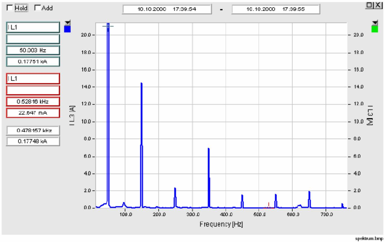
显示选定曲线图的振幅谱。
