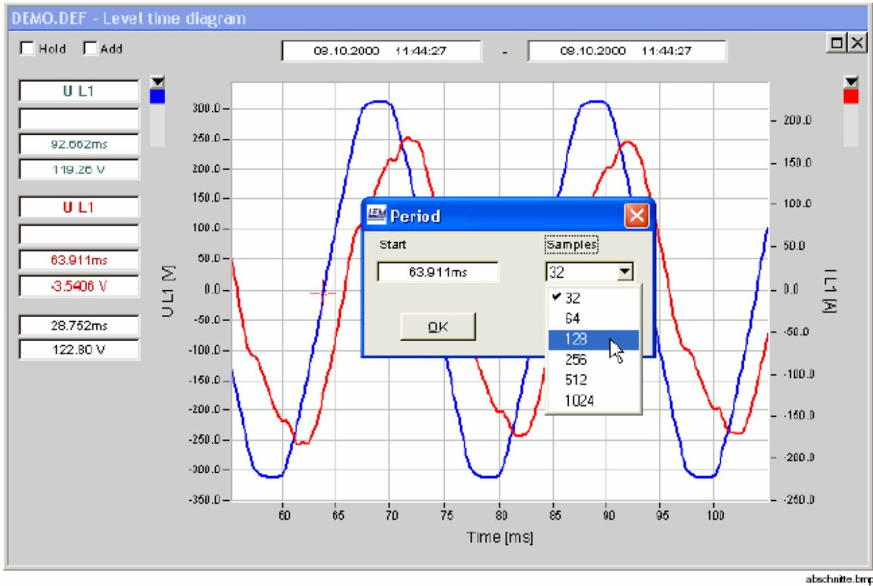
在对话框中我们可以看到起始时间，并可输入需评估的试样数量（即，段长，例如 128）。单击“OK（确定）”，关闭对话框。
