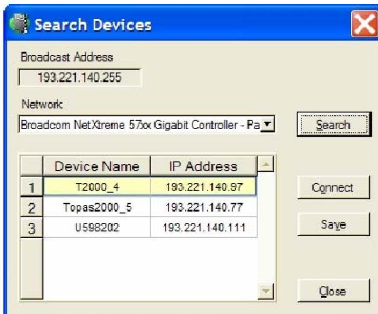
6. 选择您的仪器名称，然后按动 *Connect (连接)* 按钮在 Fluke 1760 和电脑之间建立连接，状态栏中将显示相关连接信息。
