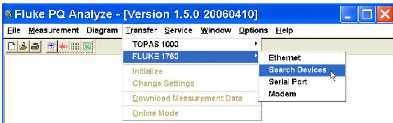
按下“ Search (搜索)”按钮，定位在网络中所查找到装置列表中的仪表。装置名称与仪表背面印刷的 7 位序号相对应。
