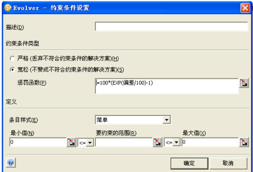
Evolver 具有默认惩罚函数，此函数在您首次输入宽松约束条件时显示。但是，可以在不符合宽松约束条件时，输入任何有效的 Excel 公式来计算要应用的惩罚数额。输入的惩罚函数应包括关键字 *偏差*，此关键字表示约束条件超出其限制时所依据的绝对量。在试验解法结束时，Evolver 会检查是否已符合宽松约束条件；如果不符合，它将在输入的惩罚公式中加入偏差量，然后计算要应用到要最小化或最大化的目标单元格值的惩罚数额。
