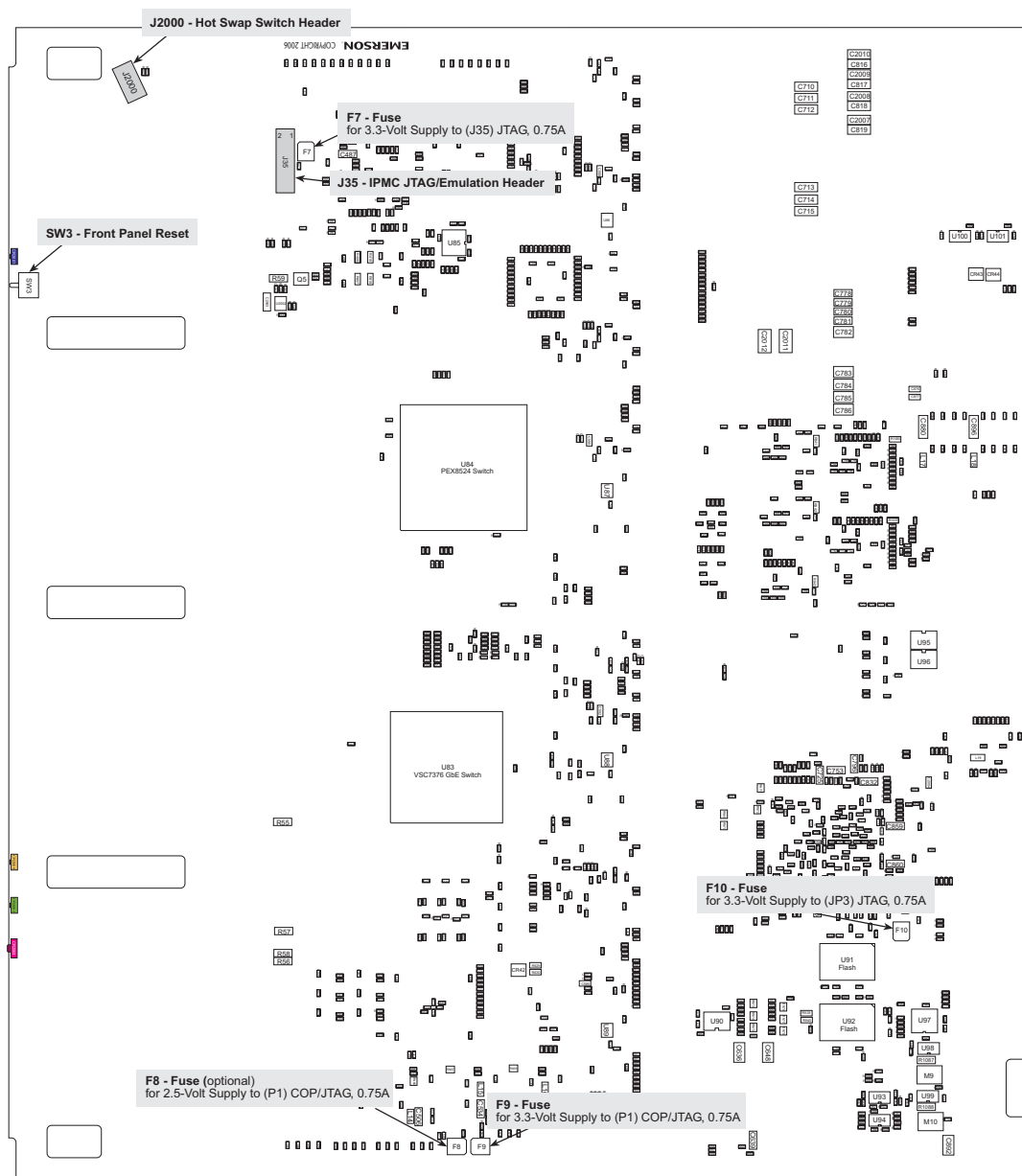
图 2-5：跳线、保险丝和开关位置，背面
