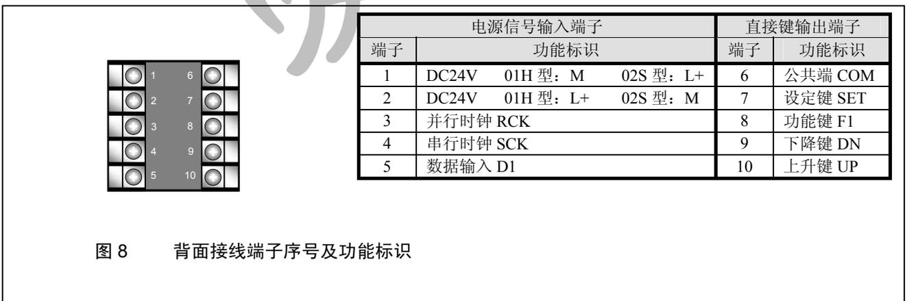
图8 背面接线端子序号及功能标识
