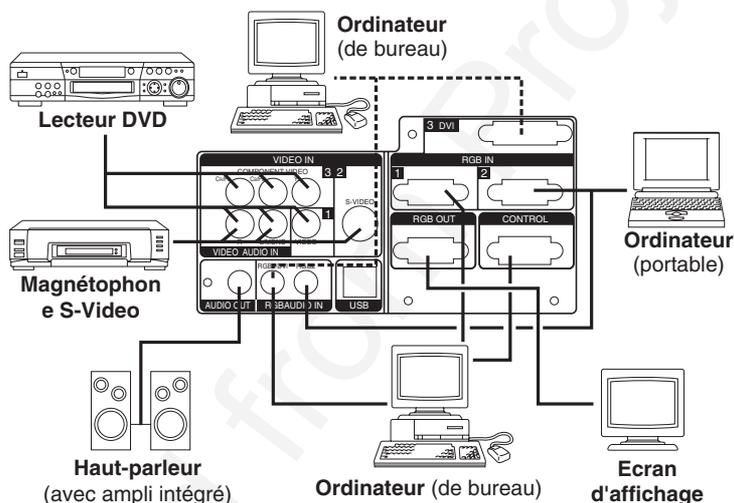
**REMARQUES** • Lors de la connexion avec un ordinateur portable, réglez pour valider la sortie vidéo RVB extérieure (réglage sur l'écran à tube cathodique ou simultanément sur l'écran LCD et à tube cathodique). Veillez vous reporter au mode d'emploi de l'ordinateur portable pour plus d'informations.
