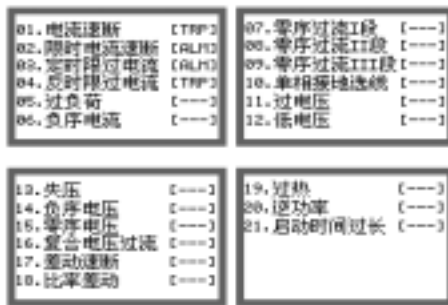
图 3.3.10g 保护功能配置显示画面
