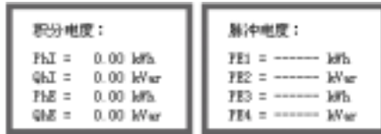
图 3.3.3 电度量数据显示画面
