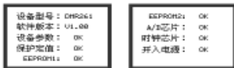
图 3.3.9 系统自检信息显示画面
