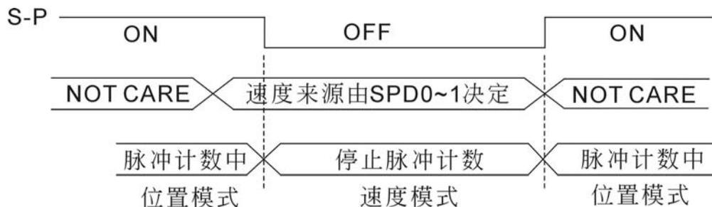
在位置模式时 (S-P 为 ON)，会计数外部脉冲，而跟随外部脉冲命令运行。当切换成速度模式之后 (S-P 为 OFF)，会自动停止计数外部脉冲，即使外部脉冲持续送出仍然不计数，速度命令由 SPD0~1 来选择，电机立刻追随命令转速旋转。当 S-P 为 ON，又立刻回到位置模式。
