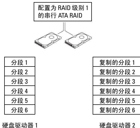
如果某个驱动器出现故障，后续的读和写操作将被定向到未出现故障的驱动器。从而可以使用未出现故障的驱动器中的数据重建备用驱动器。同时，由于数据将被复制到两个驱动器中，所以使用两个 120 GB 硬盘驱动器的 RAID 级别 1 配置最多共有 120 GB 用于存储数据。
