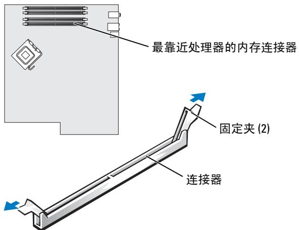
**5** 将模块底部的槽口与连接器中的横档对齐。
