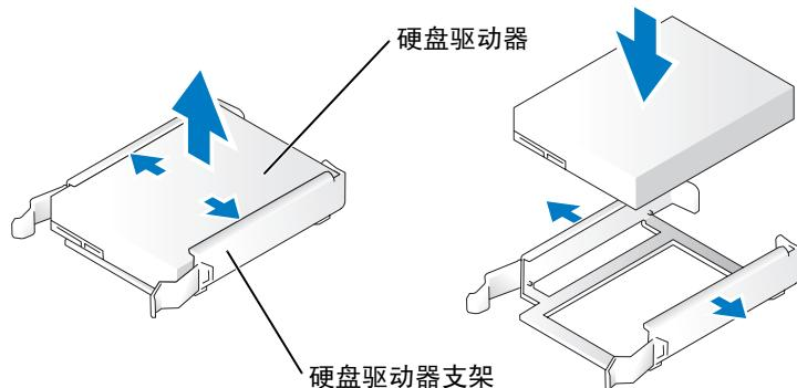
**6** 将驱动器轻轻滑入到位，直至听到咔嗒声或感觉驱动器已安装牢固。
