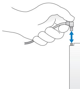
连接 IDE 电缆时，请确保将带色边线与插针 1 连接器对准。断开 IDE 电缆的连接时，请拿住并拉动带色推拉卡舌，直至连接器分开。
