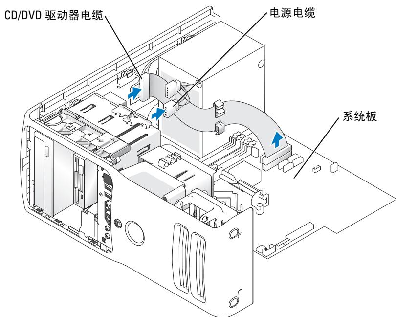
4 向右滑动驱动器释放装置以松开侧位螺钉，并将驱动器从驱动器托架中滑出以卸下。
