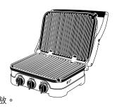
在降低把手进行烹饪之前,盖子将保持垂直 状态。降低把手之后,盖子会被释放并平放 在所烹制食物的顶部。这样,您可均匀从 上下两个面烹饪食物。当烹饪完成后提升把 手,打开煎烤机时,盖子仍处于平坦位置, 与下盘平行。为了将盖子锁定到垂直位置, 您必须在没有食物时关闭煎烤机,然后再将 其打开。
