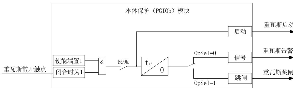
图4-7 重瓦斯本体保护原理框图 (其它本体保护原理与重瓦斯相同)
