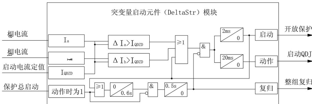
图4-1 启动元件原理框图
