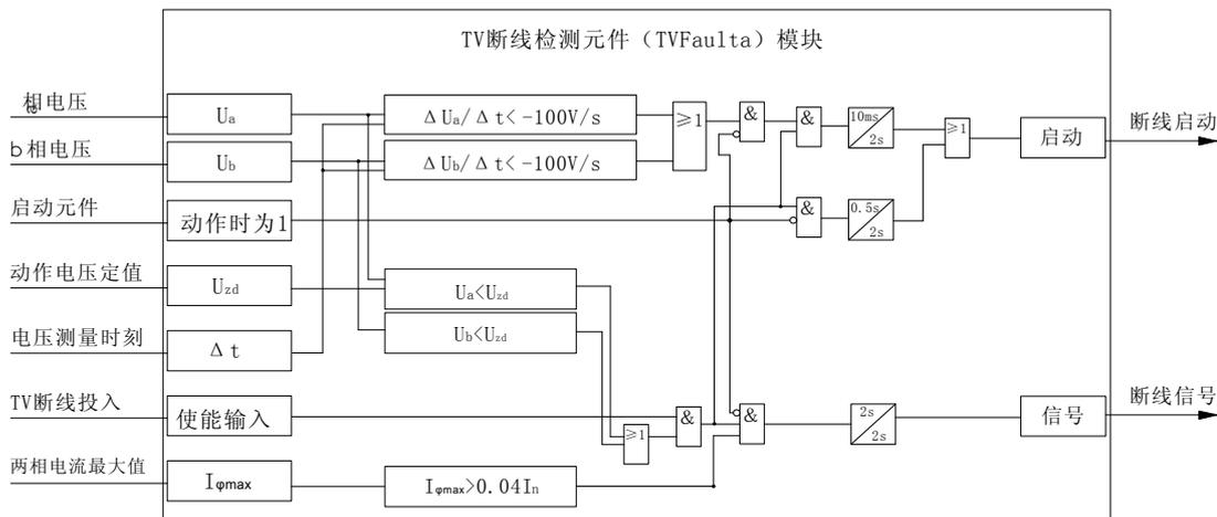
图4-5 TV断线检测元件原理框图
