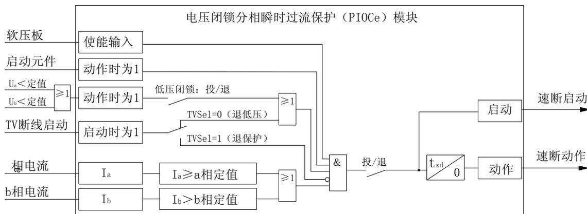
图4-2 低电压启动电流速断保护原理框图 (过流保护与速断相同)
