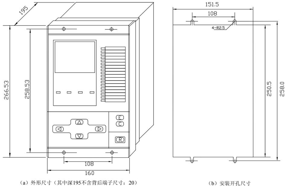
图 3-1 装置外形尺寸及安装开孔尺寸
