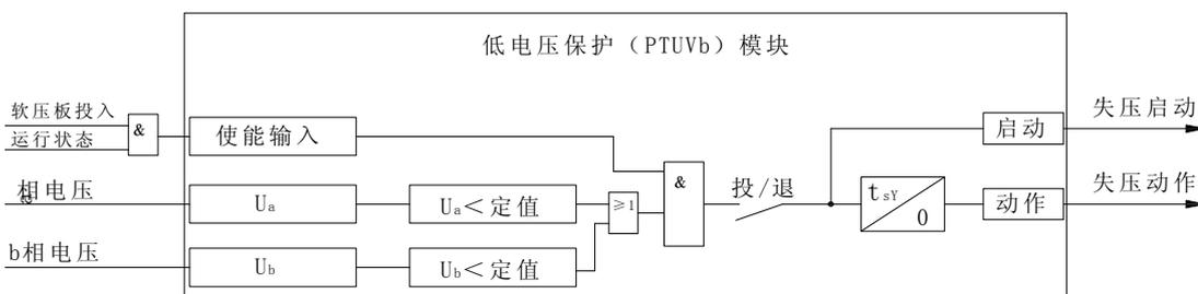
图4-4 失压保护原理框图
