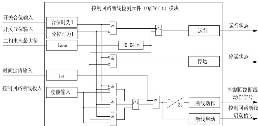
4-6 控制回路断线检测及动力变状态监视原理框图
