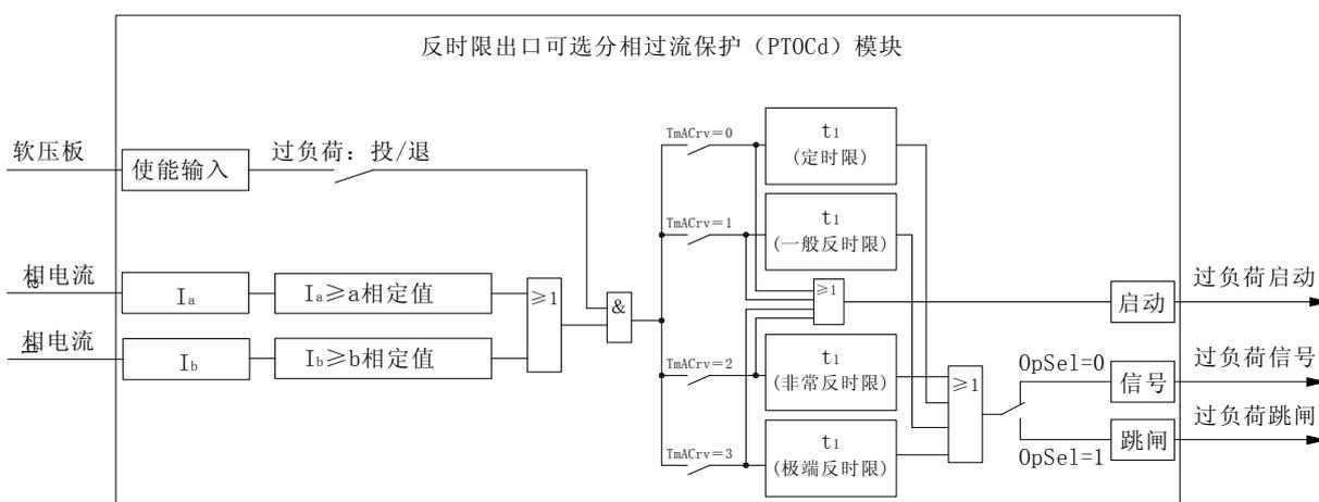
图4-3 过负荷保护原理框图
