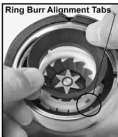
Stellen Sie sicher, dass der schwarze Einstellring so weit wie möglich gegen den Uhrzeigersinn gedreht ist. Setzen Sie das Mahlwerk wieder ein, indem Sie die rote Markierung auf dem Ringmahlwerk mit dem rechteckigen Ausschnitt auf dem schwarzen Einstellring abgleichen. Drücken Sie das Ringmahlwerk fest hinunter, um sicherzustellen, dass es richtig sitzt.
