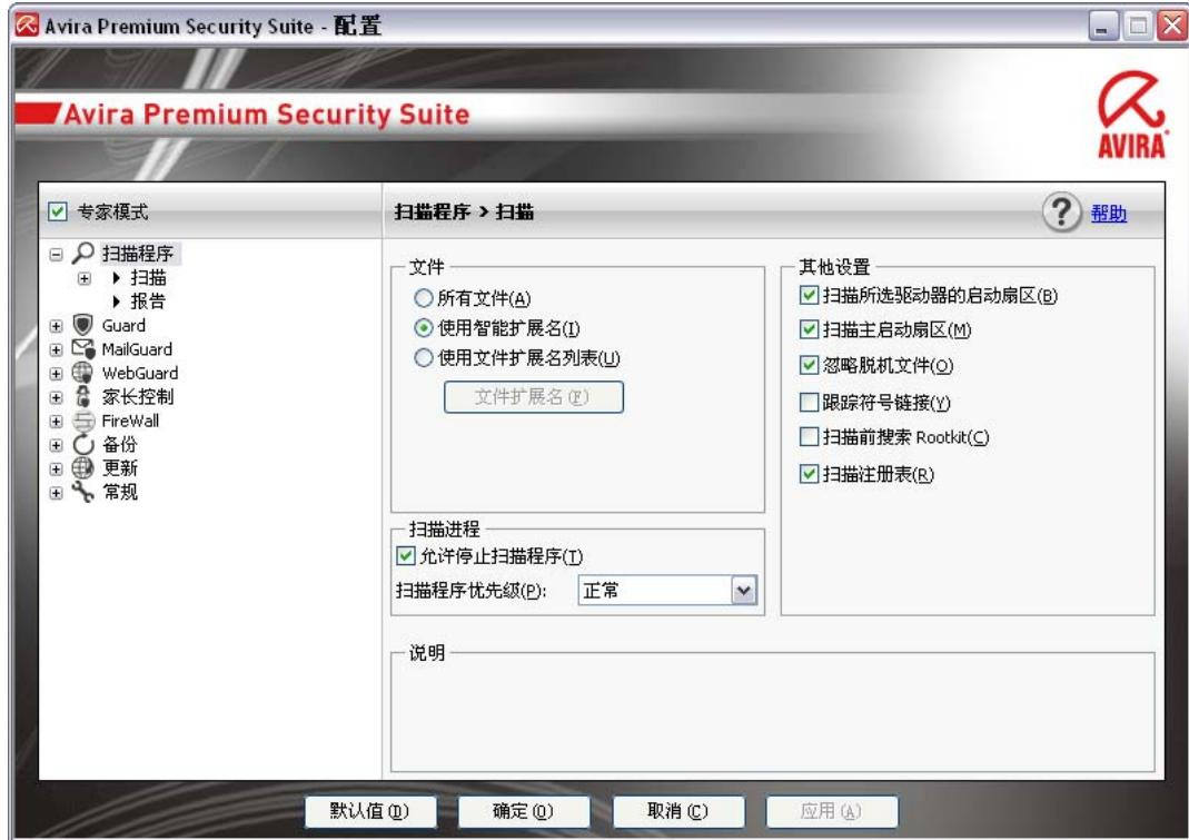
“配置”将打开一个对话框：可以通过“确定”或“应用”按钮保存配置设置，通过单击“取消”按钮删除设置，或通过使用“默认值”按钮还原默认配置设置。可在左侧的导航栏中选择各配置部分。
