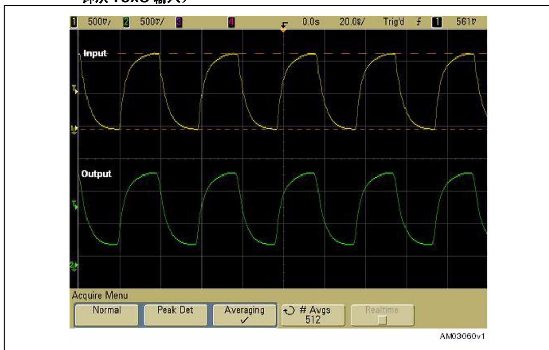
图 33. 方波输出的上升下降时间 (STCD1040, 1.8 V 版本, 10 MHz 方波主时钟输入,  $C_L = 20$  pF)
