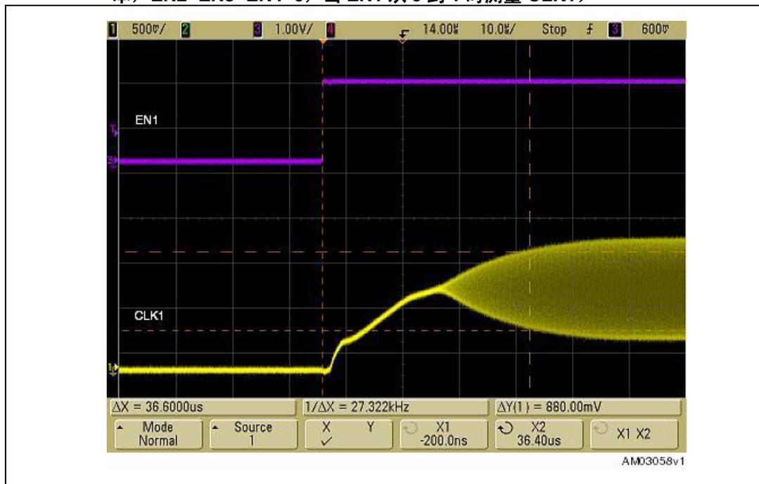
图 31. STCD10x0 缓冲器从关闭到开启所需的恢复时间 (STCD1040, 1.8 V 版本, EN2 = EN3 = EN4 = 1, 当 EN1 从 0 到 1 时测量 CLK1)
