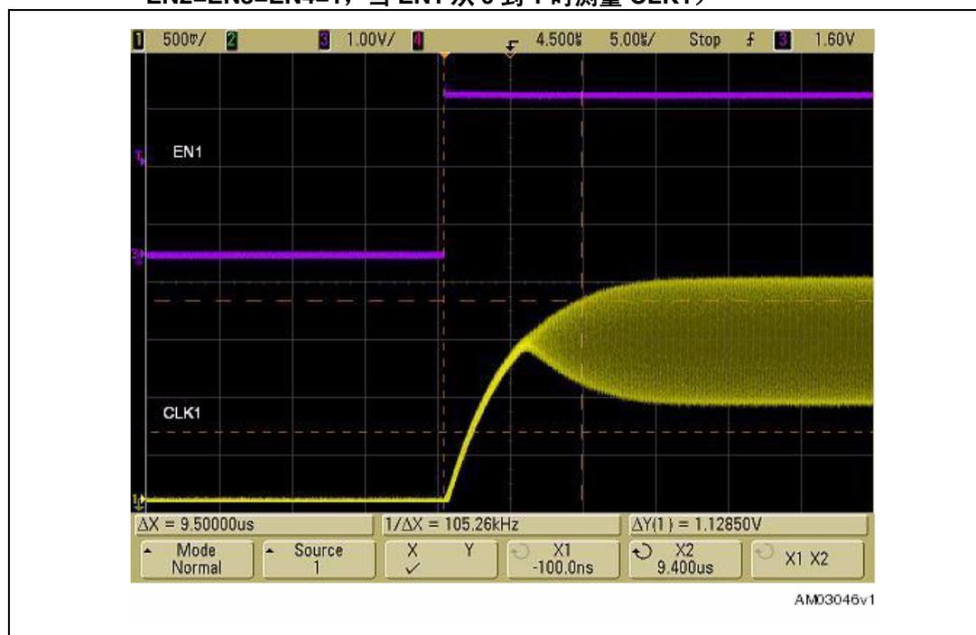
图 19. 正弦波输入时钟 vs. 输出时钟 (STCD1040, 2.8 V 版本, 26 MHz 正弦波主时钟从 TCXO 输入)
