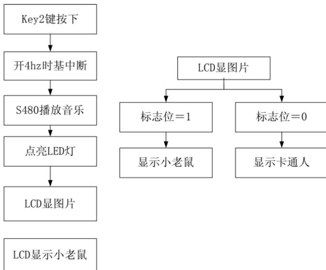
图 3.1 按下按键 2 后的程序流程图
