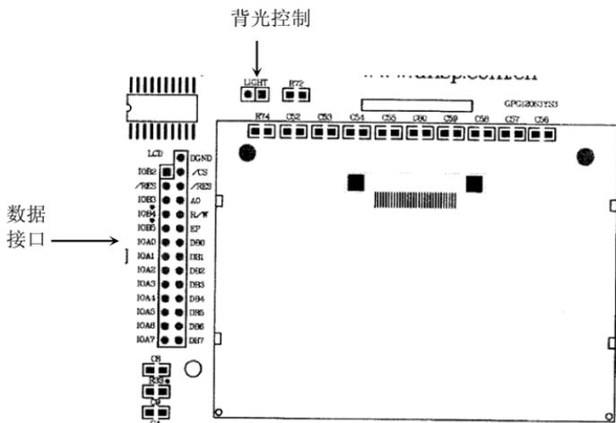
图 2.11 液晶显示电路
