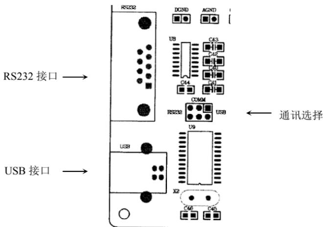
图 2.8 RS232/USB 通讯电路
