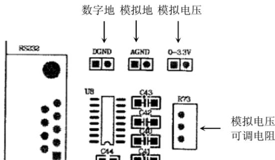
图 2.5 模拟电压输入电路
