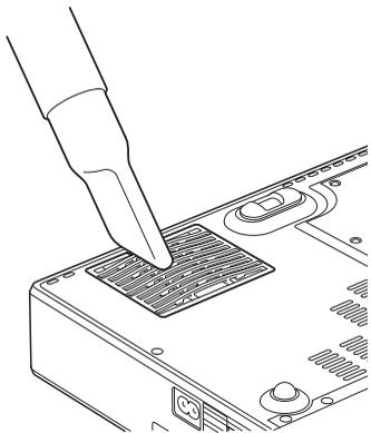
当难以用真空吸尘器清除滤网上的灰尘时，请拆下空气滤网进行清洗。
