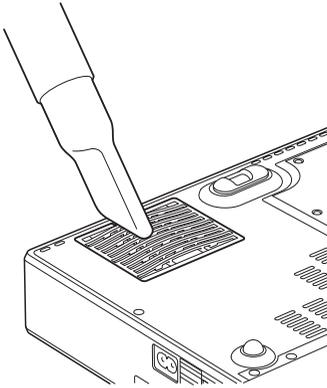
Wenn das Reinigen des Filters mit einem Staubsauger schwierig wird, bauen Sie den Filter aus und waschen Sie ihn.
