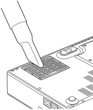
Si resulta difícil retirar el polvo del filtro con un aspirador, desmonte el filtro de aire y lávelo.
