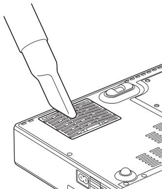
Quando diventa difficile togliere la polvere dal filtro usando l'aspirapolvere, smontare il filtro dell'aria e lavarlo.
