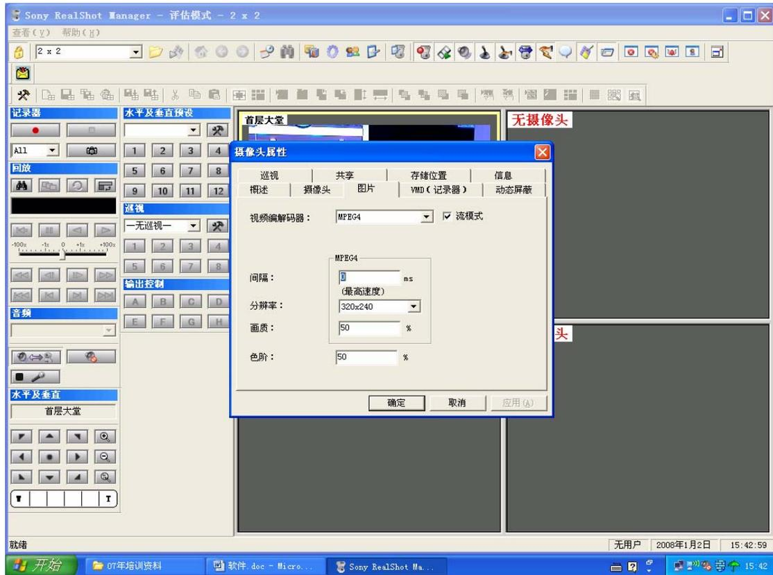
12、通过左面的“水平及垂直”控件，可以控制摄像机的云台转动及镜头变焦。
