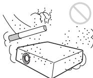
ほこりの多い場所、たばこなどの煙が入る場所での使用は避けてください。この様な場所で使用するとエアーフィルターがつまりやすくなったり、故障や破損の原因となります。また、エアーフィルターの汚れは内部の温度が上昇する原因になるので定期的に掃除してください。
