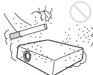
勿将本机安装在多尘或多烟雾的环境中。否则，空气滤网会被堵塞，并可能导致本机故障或损坏。灰尘会阻挡空气透过滤网，从而可能导致投影机内部温度升高。请在每次更换投影灯时清洁空气滤网。
