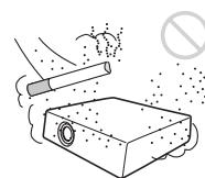
Vermeiden Sie die Installation des Geräts in sehr staubiger oder extrem rauchiger Umgebung. Andernfalls setzt sich der Luftfilter zu, was zu einer Funktionsstörung oder Beschädigung des Geräts führen kann. Ein mit Staub zugesetzter Luftfilter kann einen Anstieg der internen Temperatur des Geräts verursachen. Reinigen Sie den Luftfilter bei jedem Auswechseln der Lampe.
