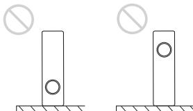
Vermeiden Sie den Betrieb bei Senkrechstellung, weil das Gerät sonst umkippen kann. Dies kann zu einer Funktionsstörung führen.
