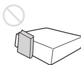
在投影期间请勿在镜头面前放置可能会遮挡光线的物品。来自光线的热量可能造成物品损坏。请使用图像静音功能停止投影。
