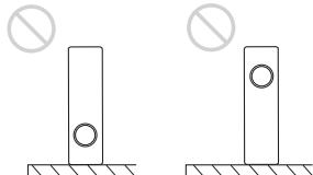
Evite utilizar la unidad en posición vertical apoyada en un lateral. Pueden producirse fallos de funcionamiento.
