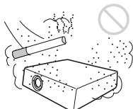
N'installez pas le projecteur dans un environnement très poussiéreux ou enfumé. Le filtre à air pourrait se colmater avec, pour résultat, un dysfonctionnement ou des dommages du projecteur. La poussière colmatée ferait obstacle au passage de l'air à travers le filtre et il en résulterait une surchauffe interne du projecteur. Nettoyez le filtre à air chaque fois que vous changez la lampe.
