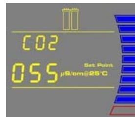
如果在 C01 選擇導電單位，那麼設定值可在  $0.999\mu\text{s}/\text{cm}@25^\circ\text{C}$  到  $0.055\mu\text{s}/\text{cm}@25^\circ\text{C}$  範圍內調節。
