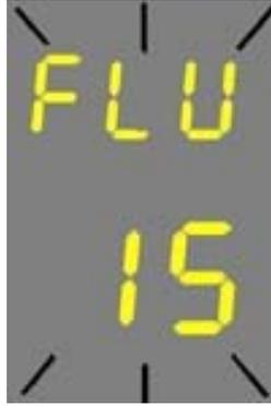
在啓動 FLUSH（沖洗）模式之前，必須清空純水儲槽中的水。如果系統檢測到純水儲槽中有水時，FLU 計數器顯示幕將閃爍。必須打開純水儲槽取水閥。當純水儲槽排空水時，系統自動重新執行 FLUSH（沖洗）模式。
