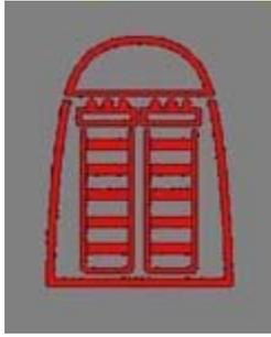
當紅色純化管柱報警器顯示為一個穩定的圖示時，表明沒有正確安裝或根本沒有安裝 SmartPak。如果已經重新安裝了 SmartPak，而仍然顯示報警圖示，請聯繫 Millipore。
