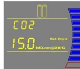
3. 按下“+”或“-”按鍵，可以在  $1.0\text{M}\Omega\cdot\text{cm}@25^\circ\text{C}$  到  $18.0\text{M}\Omega\cdot\text{cm}@25^\circ\text{C}$  範圍內調節比電阻值設定值。
