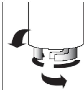
**步骤一、**向滤芯中倒入一升水冲洗一下，插入安装钥匙，逆时针旋转。
