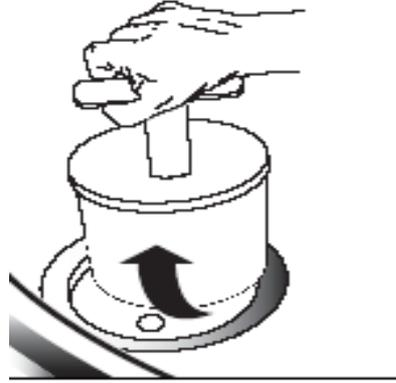
**步骤二、**拔起钥匙，拔出滤芯，倾斜滤芯，排出内部污物。
