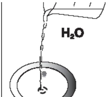
步骤五、向滤芯的进液孔中倒入 0.5 升水。
