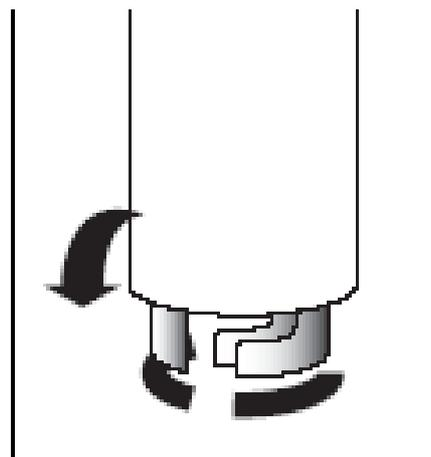
**步骤三、**将随货发运的安装钥匙插入滤芯顶部的钥匙孔内。
