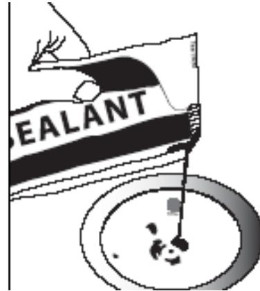
步骤七、将密封剂倒入滤芯的进液孔内，擦去孔外残留的密封剂，现在小便器可以使用了。
