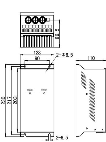
图 1 BR100-045 制动单元外形尺寸
