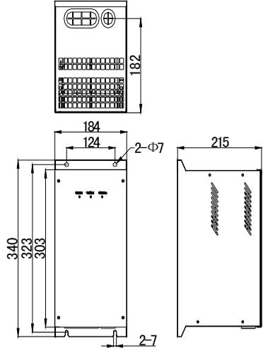
图 2 BR100-160 制动单元外形尺寸
