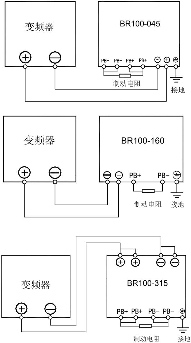
图 12 主回路连线示意图
