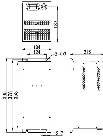
图 3 BR100-315 制动单元外形尺寸
