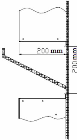
图 5 2 台制动单元上下安装示意图
