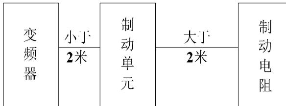
图 11 导线的长度
