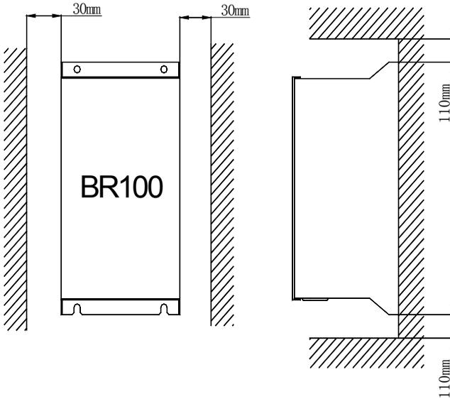
图 4 BR100 系列制动单元安装示意图
