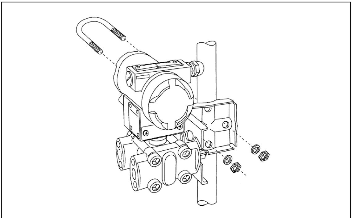
图 28 安装 SITRANS P, DS III PA 系列变送器，无支架安装（以差压，水平取压管为例）
