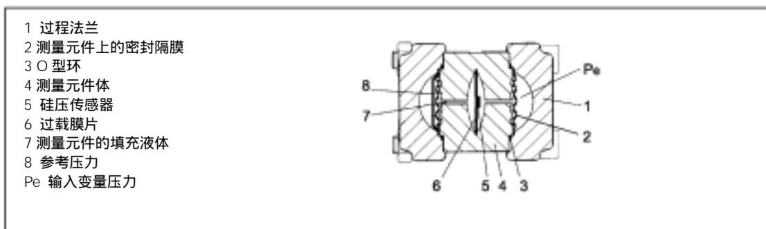
图 9 绝对压力的测量元件，功能图
