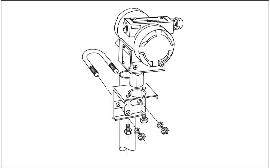
图 27 安装 SITRANS P, DS III PA 系列变送器，有支架安装
