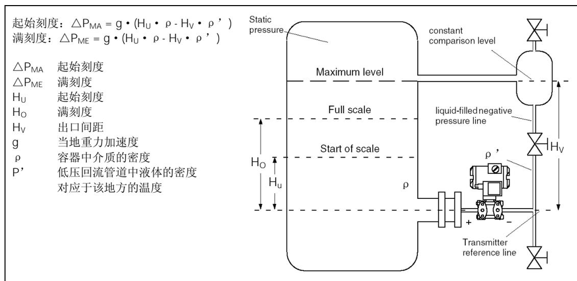
图 32 在密封容器中进行测量（重度冷凝）
