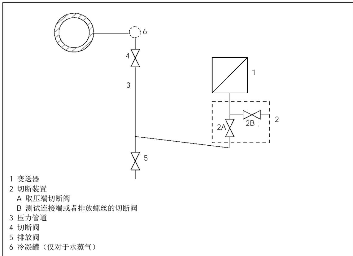
图 40 测量水蒸气
