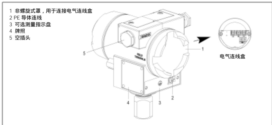
图 4 SITRANS P, DS III PA 系列设备正视图，压力序列
