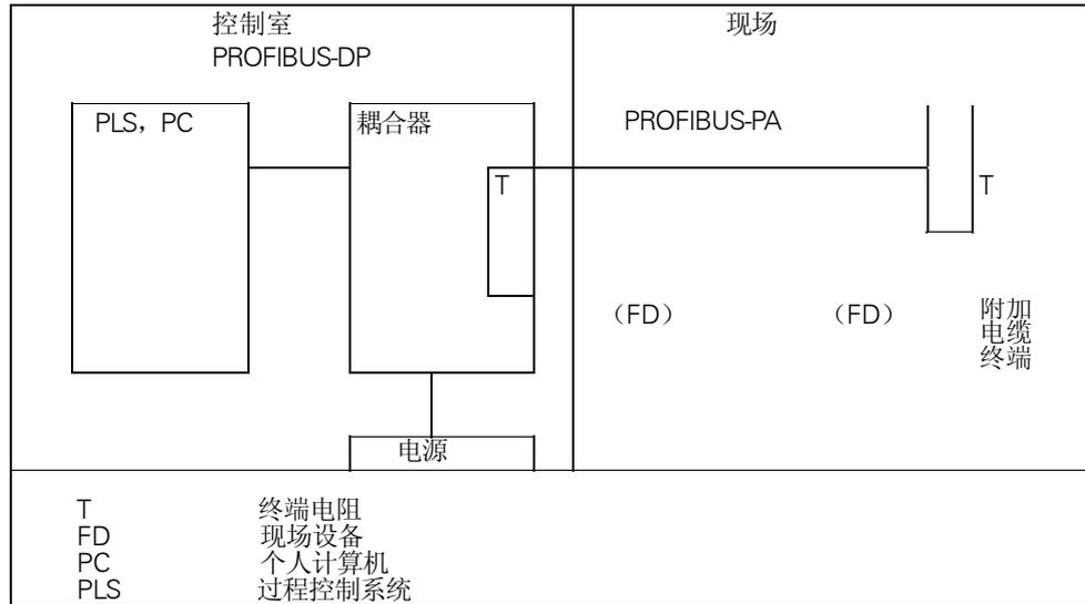
图 49 PROFIBUS-PA 的结构
