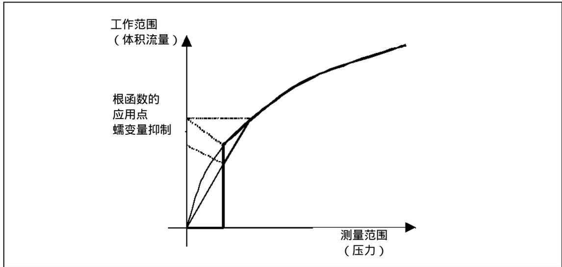
图 22 根函数的应用点和蠕变量抑制
