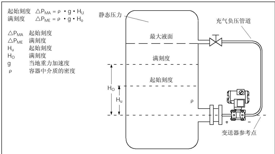
图 31 在密封容器中进行测量（没有或者仅有少量冷凝水溢出）
