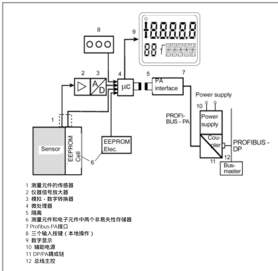
图 5 变送器 SITRANS P, DS III PA 系列, 电气
