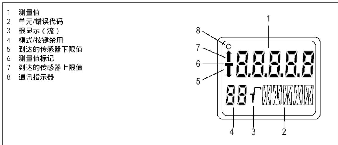
图 17 数字显示设备的结构
