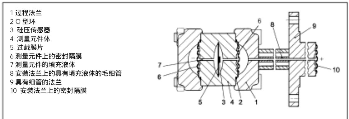
图 8 填充高度的测量元件，功能图
