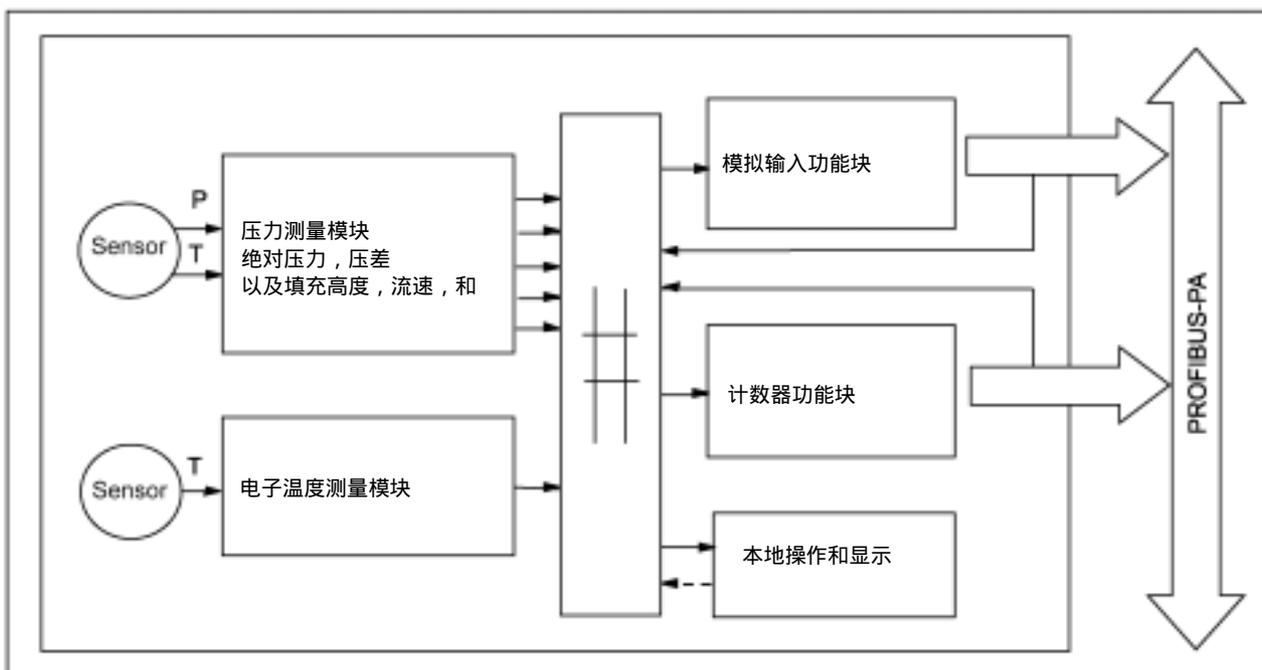
图 11 记录和处理测量值的方块接线图
