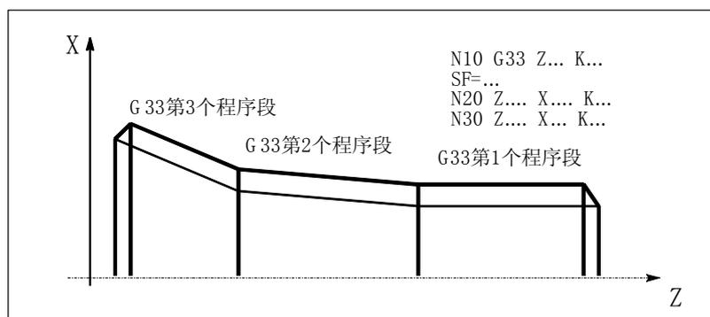
图 8-19 多段连续螺纹加工举例
