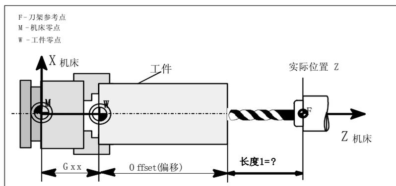
图 3-5 计算钻头长度补偿：长度 1，Z 轴
