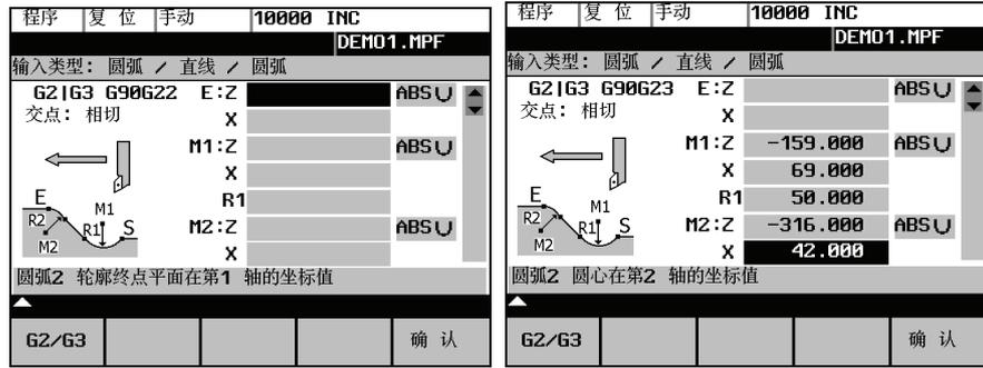
图 6-20 计算圆弧-直线-圆弧的轮廓交点
