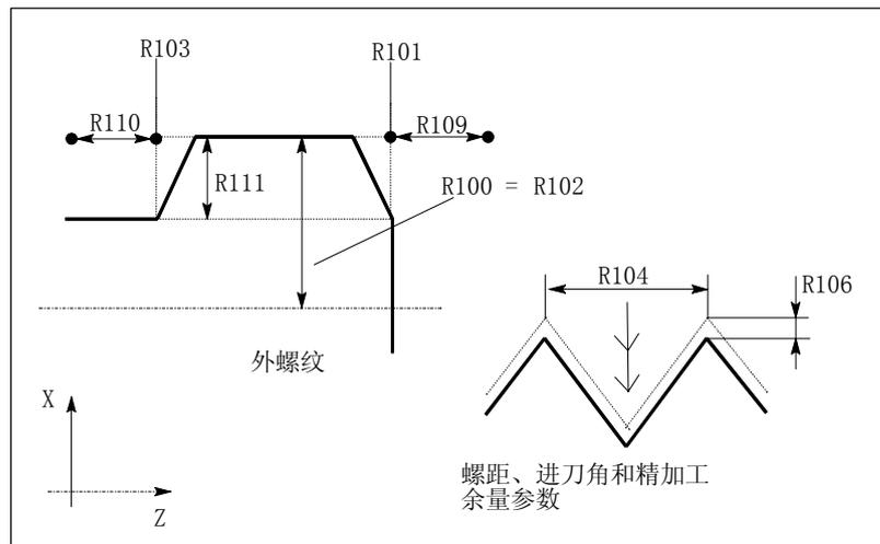
图 9-15 螺纹切削参数示意图
