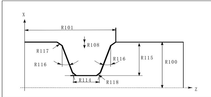
图 9-9 纵向加工时切槽循环参数
