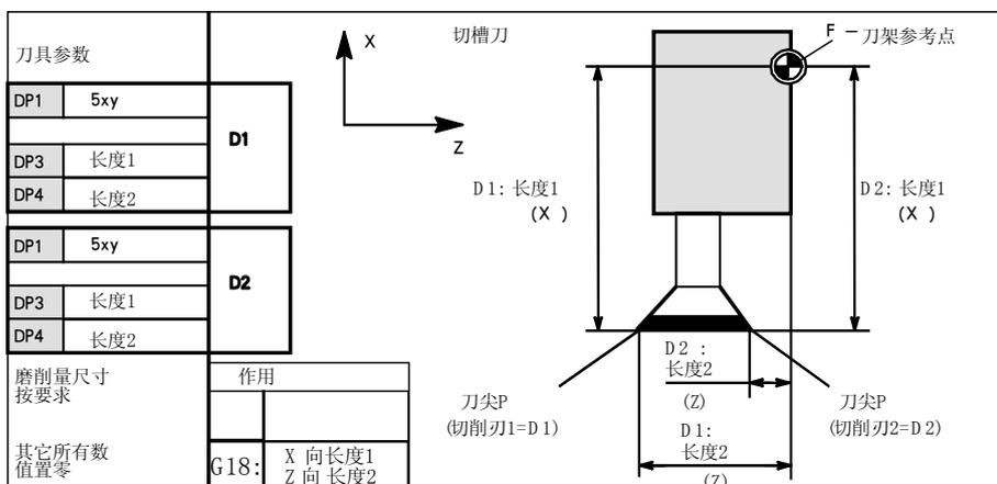
图 8-29 具有两个切削刃的车刀—长度补偿
