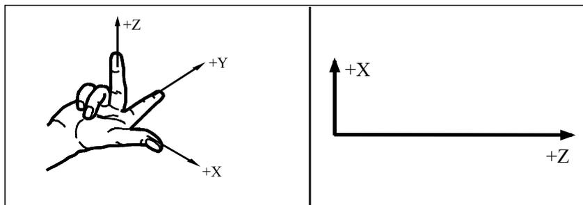
图 1-8 直角坐标系中坐标方向的规定
