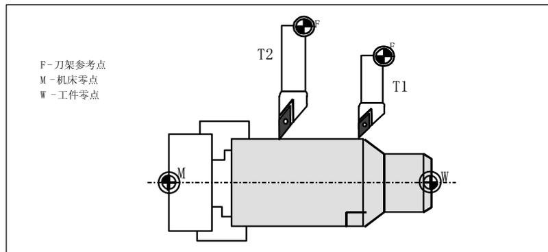
图 8-26 用不同尺寸的刀具加工工件
