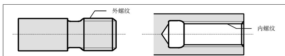
图 8-16 圆柱体内螺纹/外螺纹举例
