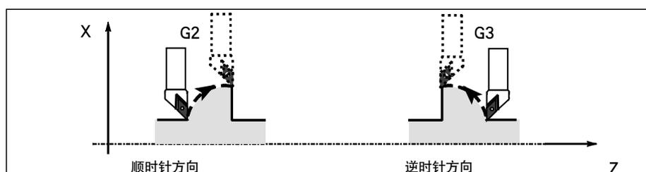
图 8-9 圆弧插补 G2/G3 的方向规定
