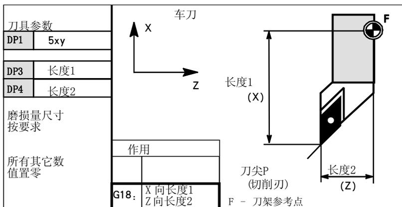
图 8-28 车刀所要求的长度补偿值
