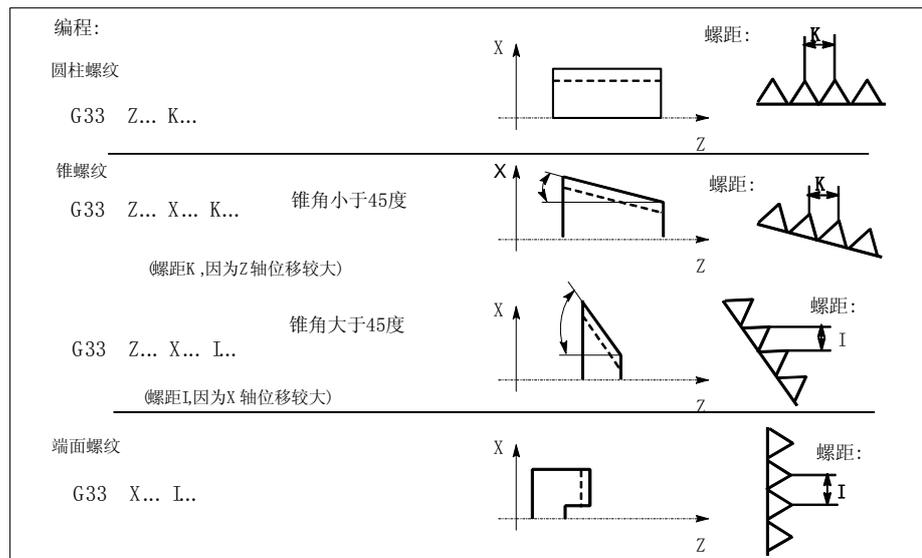
图 8-18 Z 轴/X 轴螺距举例
