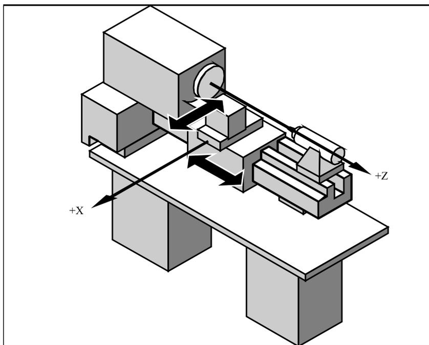
图 1-9 车床中机床坐标系/坐标轴
