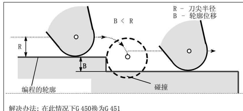
图 8-39 过渡圆弧的临界加工情况举例
