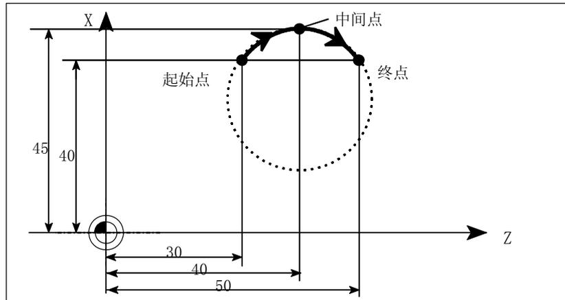
图 8-15 G90 已知终点和中间点的圆弧插补
