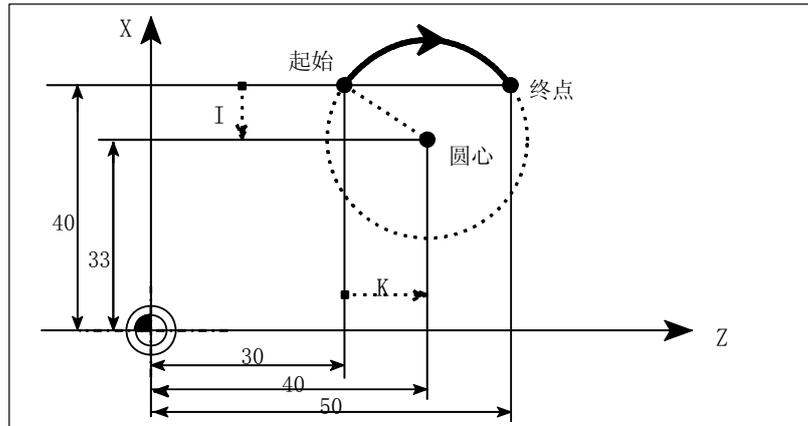
图 8-11 圆心坐标和终点坐标举例
