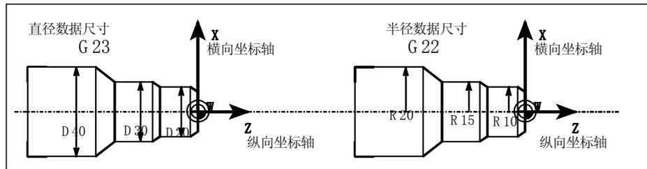
图 8-4 横向坐标轴中直径和半径数据尺寸
