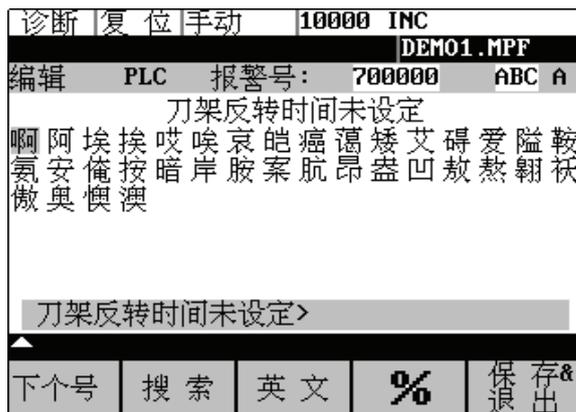
图 7-14 用于编辑 PLC 报警文本的屏幕格式
