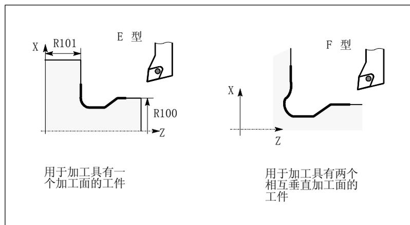
图 9-11 E 型和 F 型退刀槽切削
