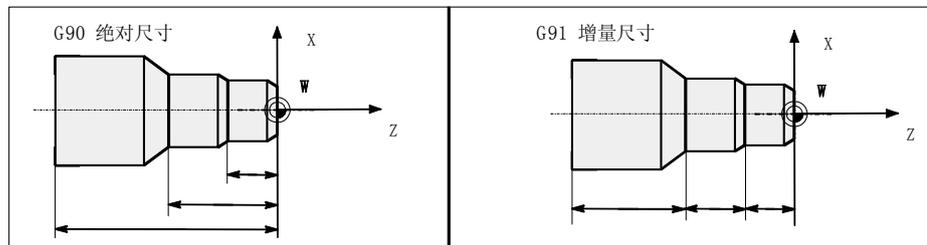
图 8-3 图纸中不同的数据尺寸
