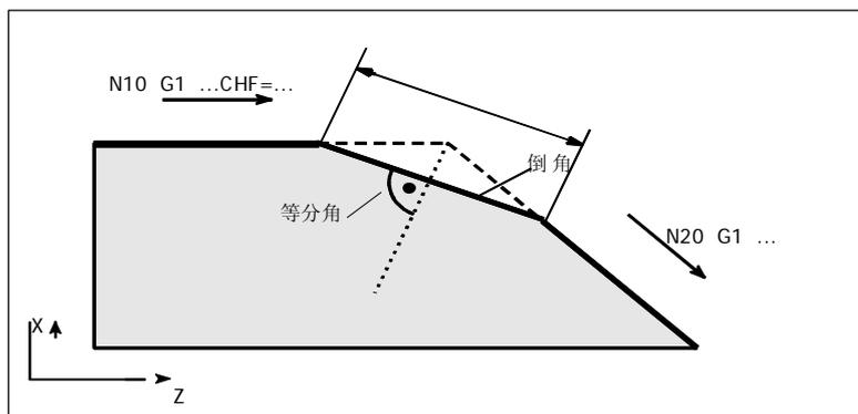
图 8-24 两段直线之间倒角举例
