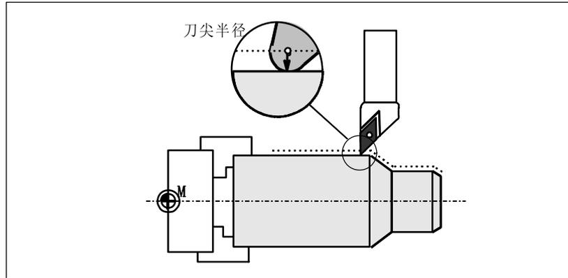
图 8-33 刀尖半径补偿(切削刃半径补偿)
