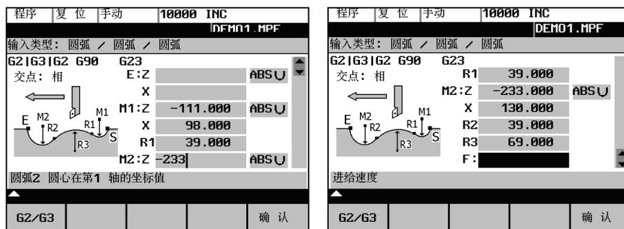
图 6-30 圆弧—圆弧—圆弧屏幕格式
