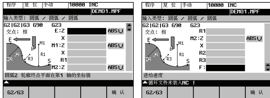
图 6-27 计算圆弧—圆弧—圆弧轮廓的屏幕格式
