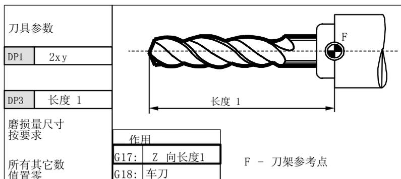
图 8-31 钻头所要求的补偿参数
