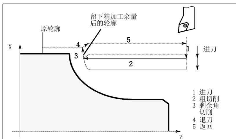
图 9-13 循环 LCYC95 的时序过程
