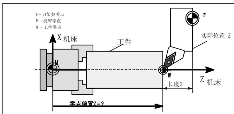
图 3-8 计算 Z 轴零点偏置值
