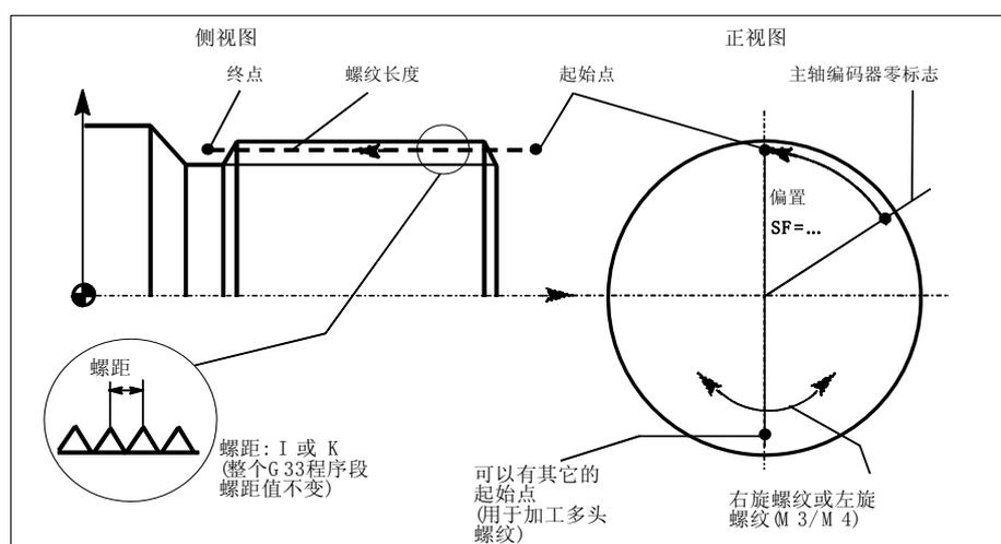
图 8-17 G33 螺纹切削中可编程的尺寸量
