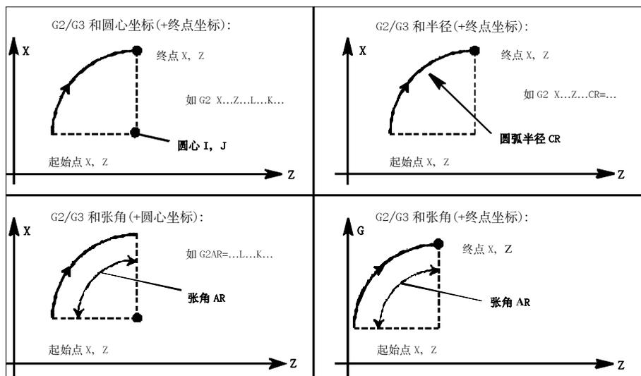
图 8-10 圆弧编程的几种方式
