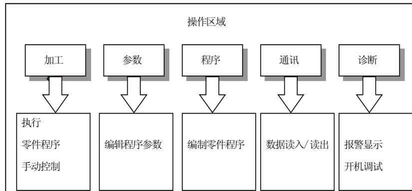
图 1-2 SINUMERIK 802S/C base line 操作区域
