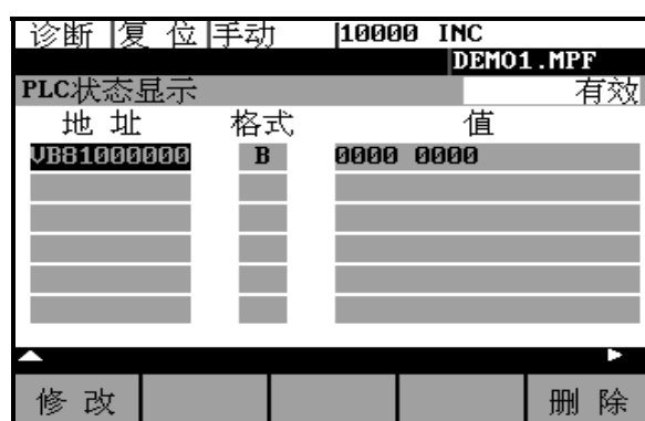
图 7-9 PLC 状态显示
