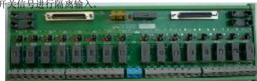
XS-32AIO (FM-16AIO) 32(16)路多功能模拟信号输入输出模块 (端子板), 主要是配合 DCS(或 PLC)模拟量输入输出模块使用。 通过跳线可拼接出各种电压、电流、数字信号输入输出及电偶信号输入, 可配接各种热电偶、两(三、四)线制变送器、单元仪表、阀门定位器、电气转换器等模拟信号设备及有源开关、无源开关、小型电磁阀等。
