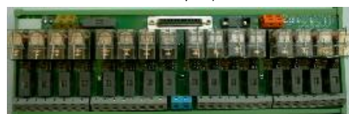
XS-32DO(FM-16DO) 32(16)路多功能通用继电器隔离数字输出模块 (端子板), 配合DCS(或PLC)数字信号输出模块使用。 输入型式: 线圈侧共阴\共阳选择; 输出型式: 有源输出、无源常开接点、无源常闭接点。可用来控制电动机、电磁阀等装置。
