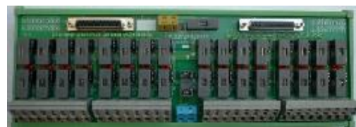
FM-32DIO 32路非隔离输入输出模块 (端子板), 主要是配合无需隔离的 DCS(或 PLC)输入输出模块使用。适用于有源开关、无源开关、小型电磁阀等设备连接
