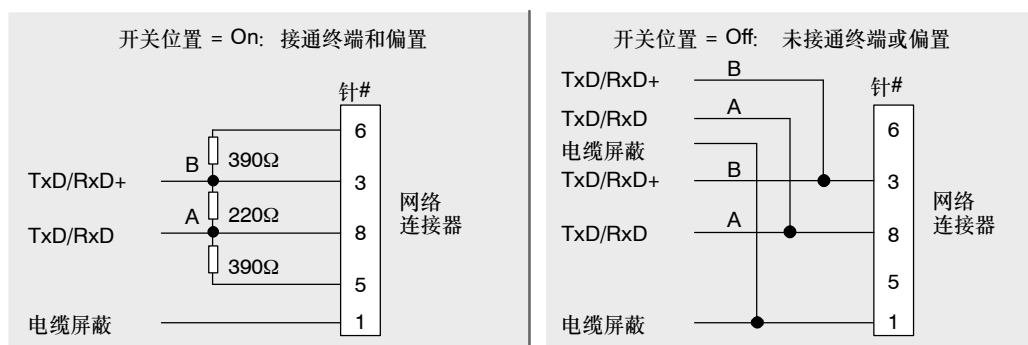
图11-5 网络电缆的偏置和终端
