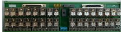
XS-32DI(FM-32DI) 32路多功能继电器隔离数字输入模块 (端子板), 主要是配合DC(或PLC)数字信号输入模块使用。 输入线圈侧可进行有源、无源开关输入选择。可用来对来自危险场合的开关信号进行隔离输入。
